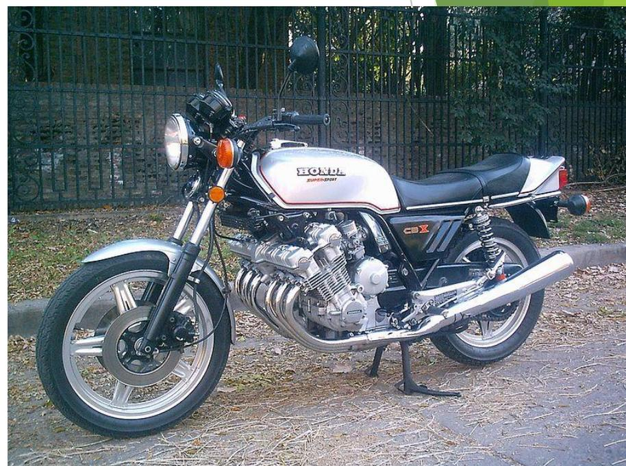
6-цилиндровый двигатель с естественным охлаждением на мотоцикле (Honda CBX1000, 105 лс.)
