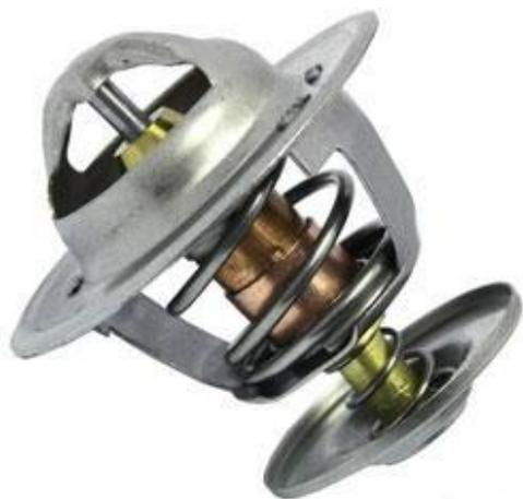
Данный клапан является основным клапаном, перекрывающим связь радиатора с рубашкой охлаждения при небольшой (менее 70 °С) температуре ОЖ. В этом случае ОЖ циркулирует по малому кругу охлаждения, в который входят рубашка охлаждения и жидкостная полость водяного насоса.
