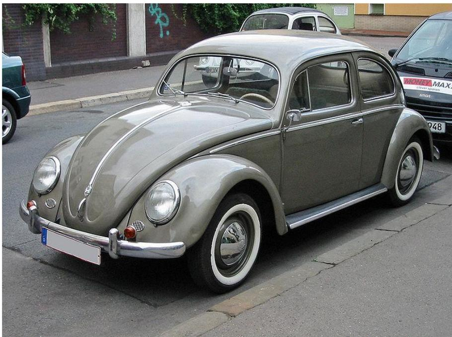
Фольксваген Жук с стационарным двигателем принудительного воздушного охлаждения
