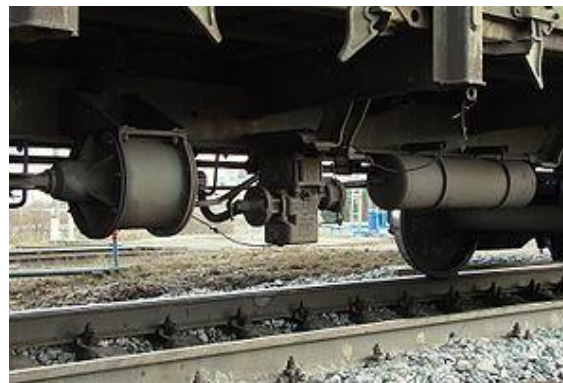
Стояночный тормоз вагона-хотпера
