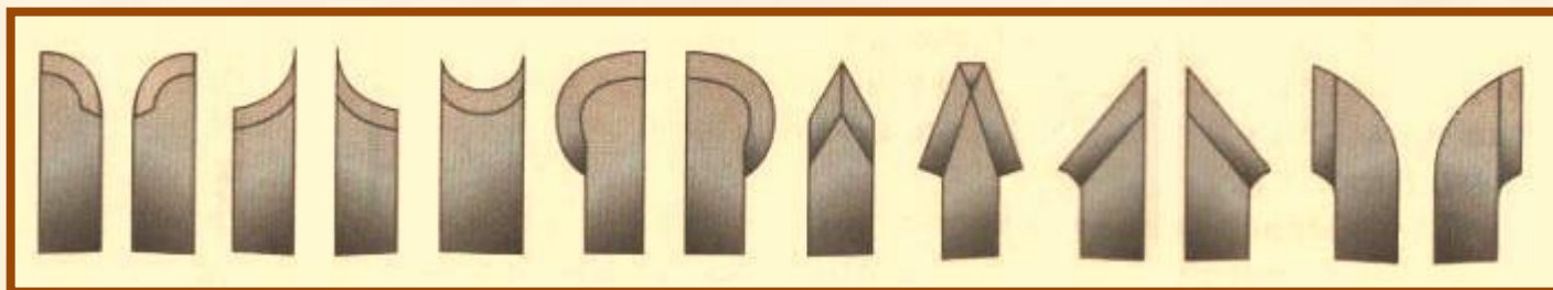
Рис 1. Профили поверхности детали и профили стамесок.
