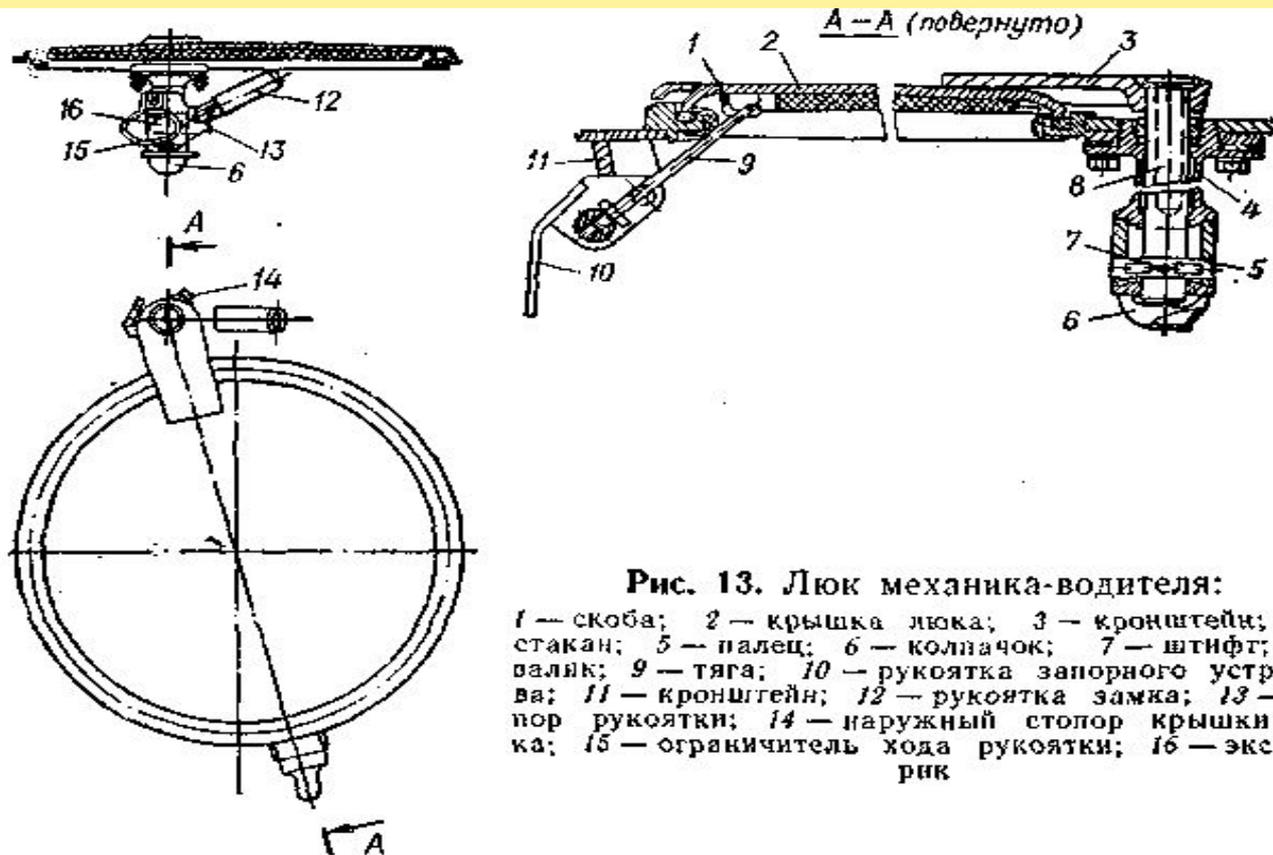
**Рис. 13. Люк механика-водителя:**
