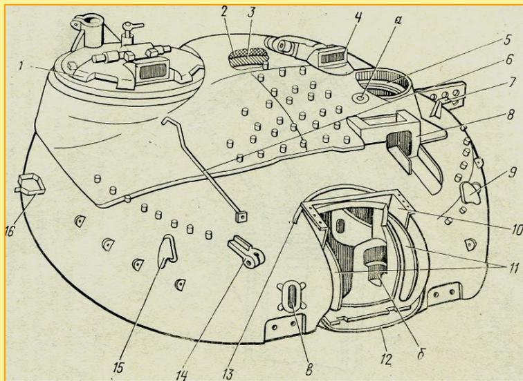
**Башня** представляет собой фасонную отливку из броневой стали, к верхней части которой приварены крыша, защитная головка 8 прицела-дальномера.
