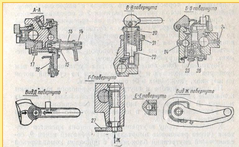
Командирская башенка предназначена для обеспечения наблюдения командиром машины за местностью. На командирской башенке смонтирована зенитная установка.
