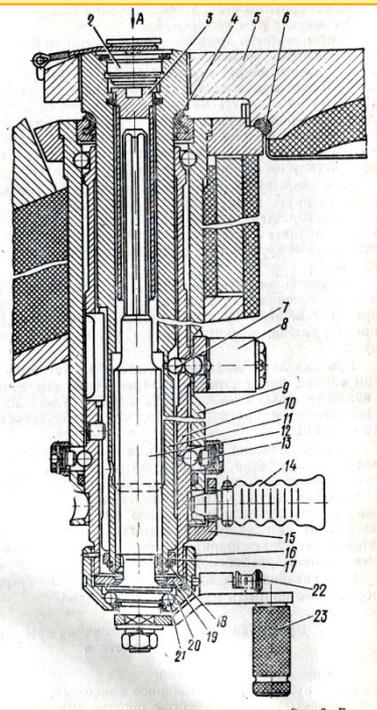
Люк механика-водителя расположен в средней части переднего листа крыши корпуса над сиденьем механика-водителя и закрывается крышкой 5 с помощью закрывающего механизма.
