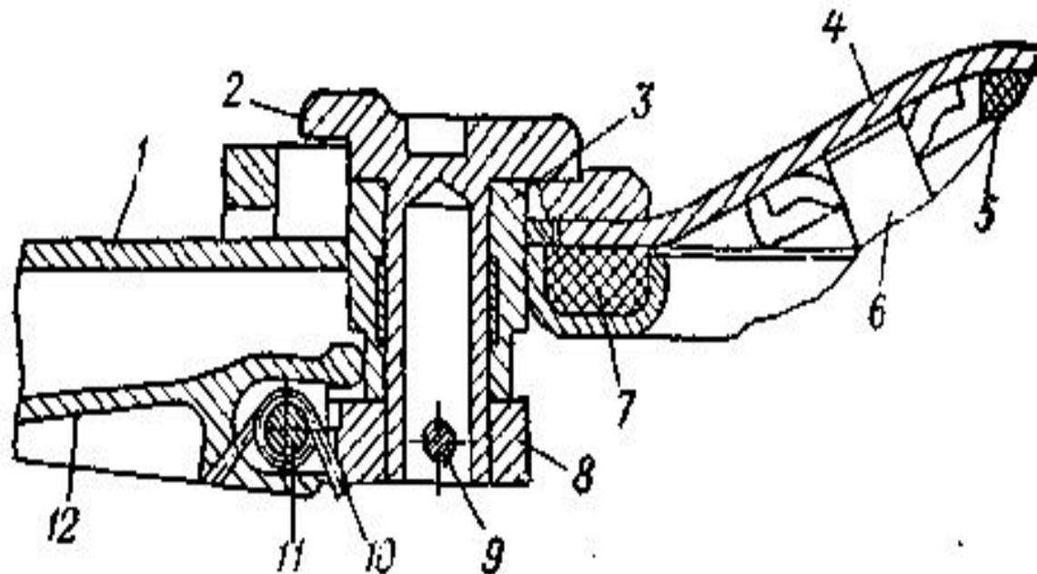
Рис. 15. Замок крышки люка десантного отделения:
