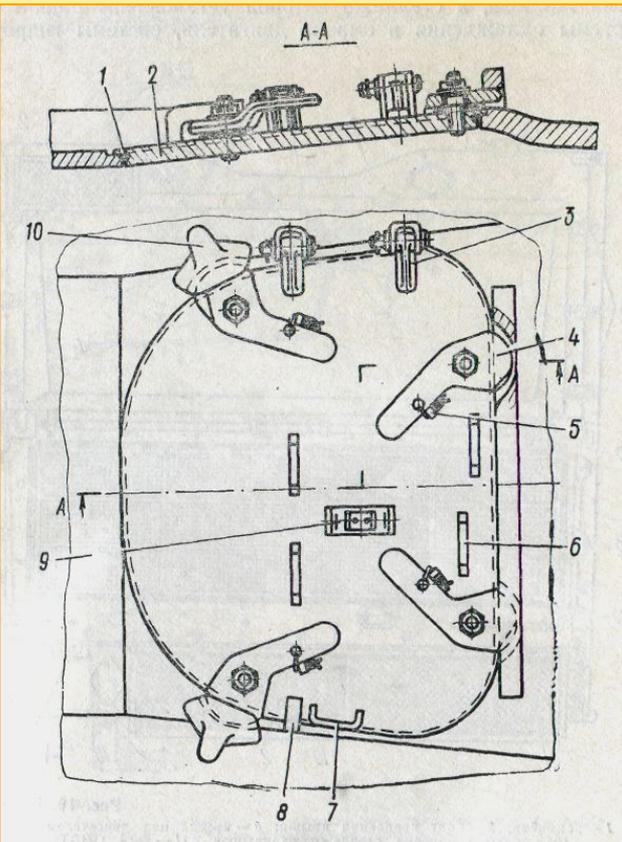
Люк запасного выхода расположен за сиденьем механика-водителя. Крышка 2 люка упирается на расточку днища и уплотняется резиновой прокладкой 1. Крышка люка установлена на петлях 3 и запирается четырьмя задрайками 4. Задрайки в закрытом положении стопорятся проволокой за упоры 5. Клипсы 9 предназначены для крепления лопаты, а скобы 6 - для крепления комплекта ПХЗ. Для открывания крышки люка запасного выхода необходимо:
