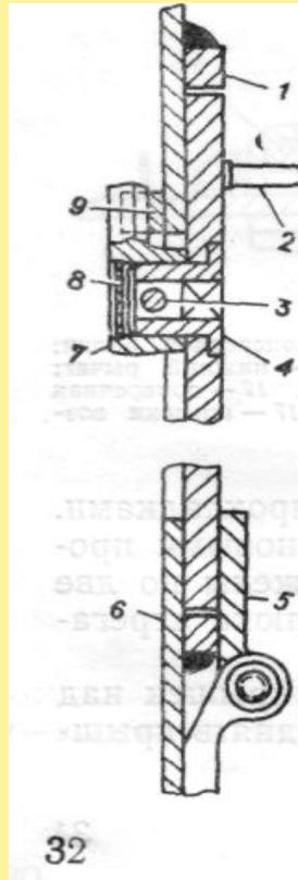
**Рис. 4.13. Крышка люка заливной горловины топливного бака:**
