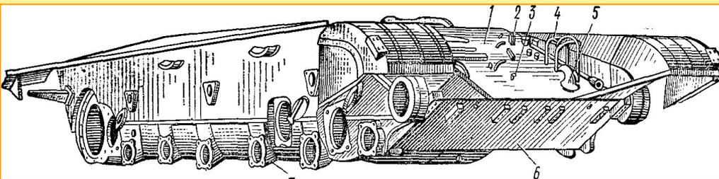
**Корпус танка** представляет собой жесткую коробку, сваренную из броневых листов. Он состоит из носовой части, бортов, кормы, днища, а также вентиляторной перегородки, перегородки МТО и крыши над МТО.
