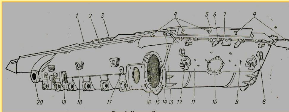
**Борта корпуса** - вертикальные броневые листы, в верхней средней части которых сварены подбашенные защитные планки **1** для увеличения внутреннего объема корпуса и установки башни.
