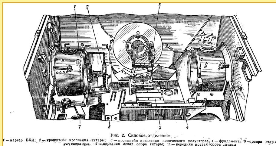
**В МТО** расположены картеры 16, в которые устанавливаются коробки передач. В передней части МТО к днищу приварены подмоторный фундамент с опорой под установку стартера-генератора и левой; передней опорой гитары. Правая передняя опора гитары приварена к днищу и правому картеру. У правого картера установлен кронштейн для крепления гитары. Между фундаментом и вентиляторной перегородкой к днищу приварен кронштейн для крепления конического редуктора привода вентилятора.
