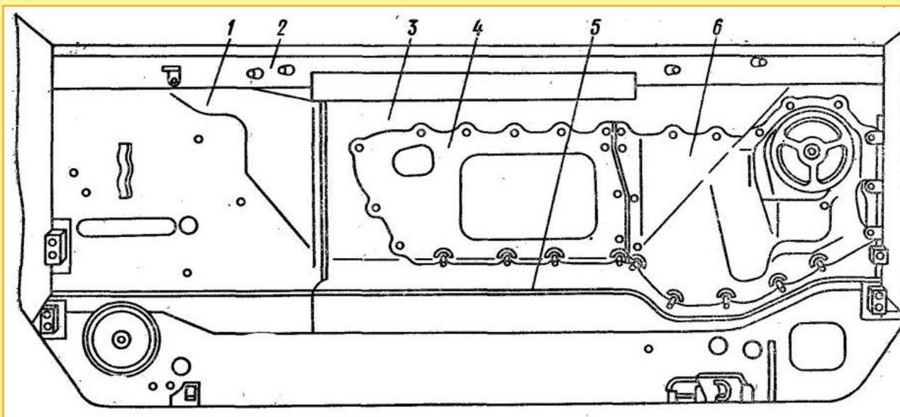
**Перегородка**, отделяющая МТО от боевого, приварена к поперечной балке, к бортам и днищу. Она состоит из сваренных между собой ребра и двух штампованных листов. На левом листе размещен люк с крышкой, состоящей из двух частей.
