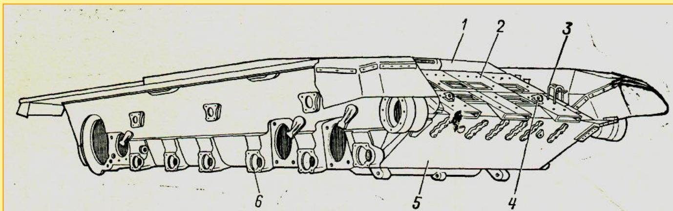
**Носовая часть корпуса** состоит из верхнего 1 и нижнего 5 наклонных броневых листов, сваренных между собой, а также с передним листом крыши, бортами и днищем.
