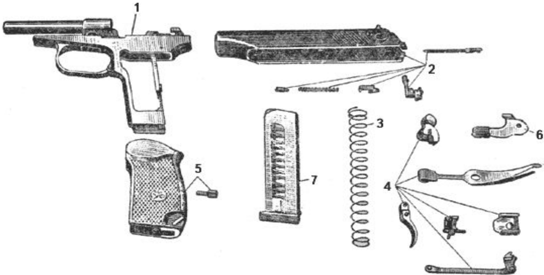
1 - рамка со стволом и спусковой скобой; 2 - затвор с ударником, выбрасывателем и предохранителем; 3 - возвратная пружина; 4 - части ударно-спускового механизма; 5 - рукоятка с винтом; 6 - затворная задержка; 7 - магазин
