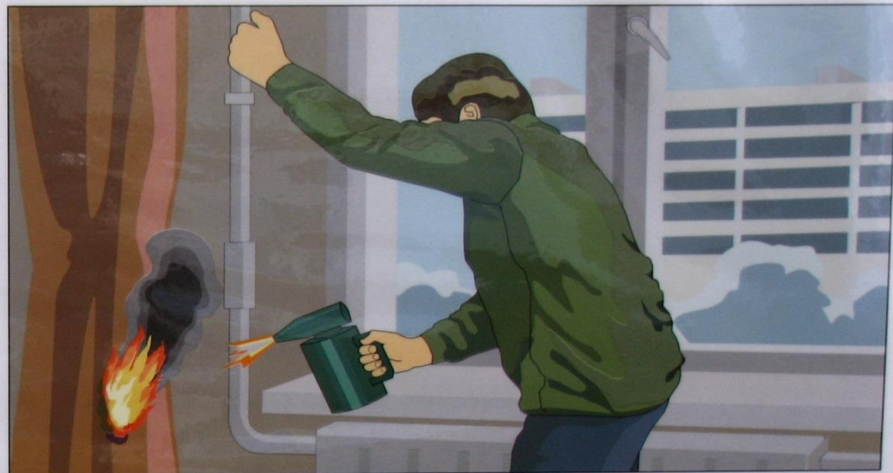
Отогревание замёрзших труб паяльными лампами и факелами
