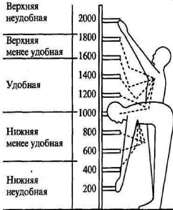
Рис. 5. Расположение удобных и неудобных зон на рабочем месте (все размеры указаны в миллиметрах): a, б - на верстаке: 1, А - удобные; 2, Б - менее удобные; 3, В - неудобные; в - удобные и неудобные зоны досягаемости по высоте
