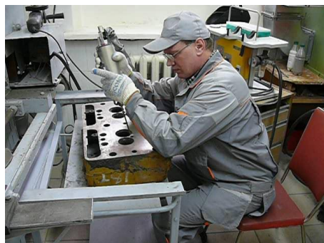
Заделка трещин газодинамическим напылением
