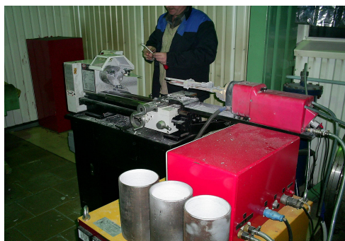
Металлизация алюминией муфт нефтебурильной установки
