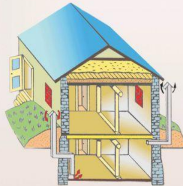
ПРИСПОСОБЛЕНИЕ ПОДВАЛА КАМЕННОГО ДОМА ПОД УКРЫТИЕ
