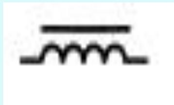
Обозначение катушки с сердечником на схеме.
