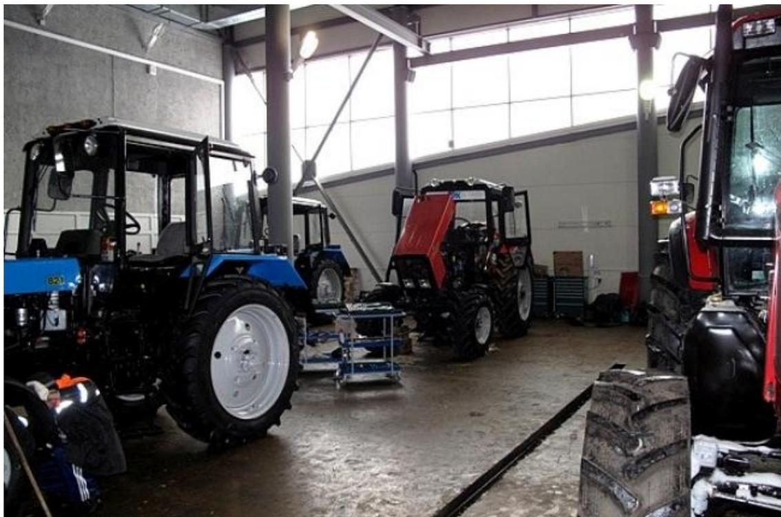
При поточном способе машины разбирают и собирают на специализированных рабочих местах поточных линий с определенной технологической последовательностью и ритмом. Поточный способ обеспечивает высокую производительность труда, эффективное использование специализированного оборудования, создаёт условия для достижения высоких показателей качества ремонта. Данный способ следует применять при большой технологической программе, а элементы его можно использовать в крупных мастерских хозяйствах.
