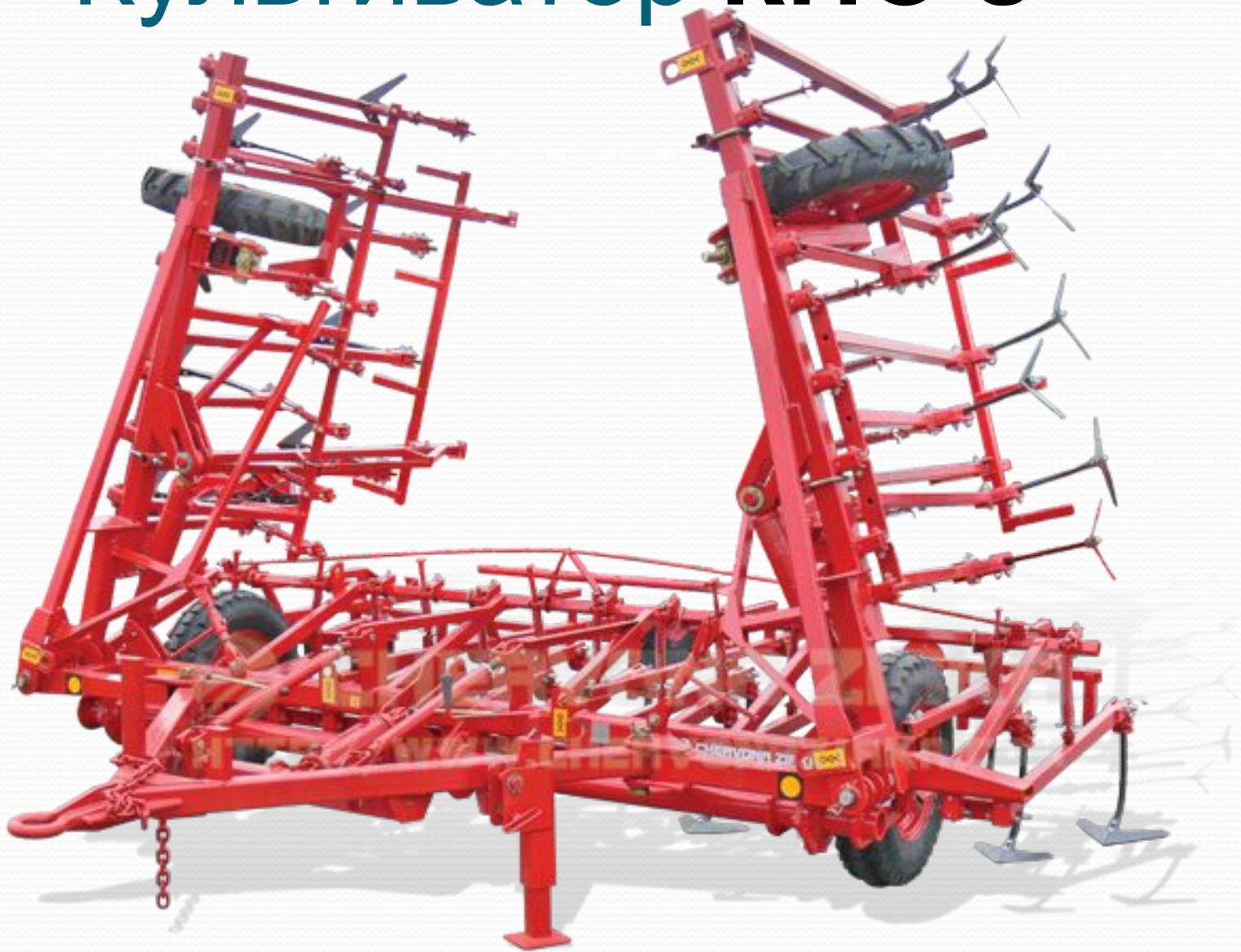
предназначен для сплошной предпосевной обработки почвы и обработки паров с одновременным боронованием. Оборудован приспособлением для присоединения зубовых или пружинных борон. Обеспечивает качественное рыхление почвы на заданную глубину (5-12 см) с уничтожением сорняков.
