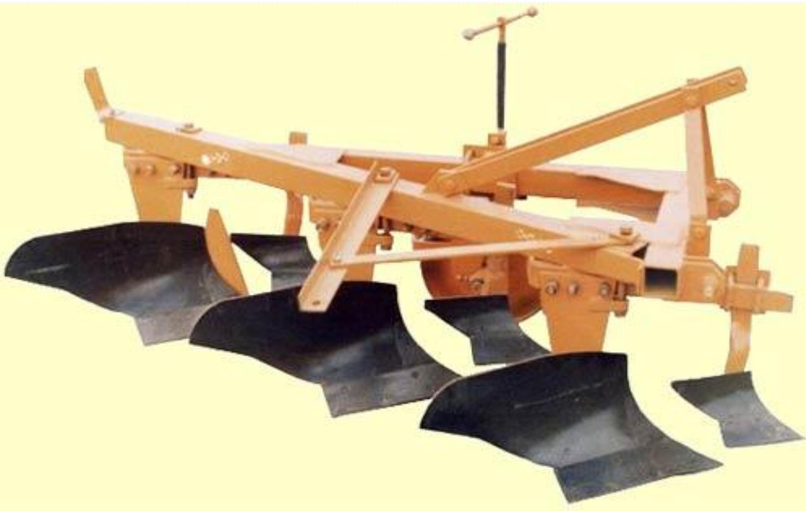
**Плуг лемешной полунавесной ПП 9-35 предназначен для пахоты почв, не засоренных камнями, плитняком и другими препятствиями, на глубину до 30 см под зерновые и технические культуры.**
