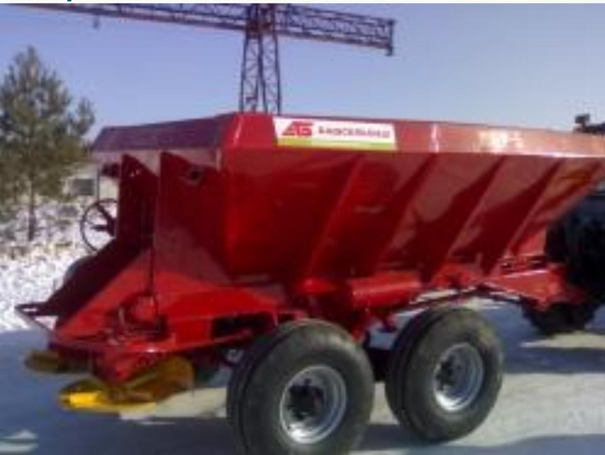
**Разбрасыватель органических удобрений РОУ-6 предназначен для поверхностного разбрасывания органических удобрений, компостов, торфокрошки и тому подобное.**
