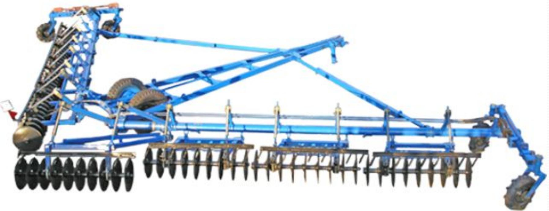
**Полунавесной плуг-луцильник ППЛ-10-25 предназначен для лущения стерни на глубину до 12 см на полях, засоренных корнеотпрысковыми сорняками, для предпосевной обработки почвы, для обработки парового поля на глубину 6-14 см и вспашки легких почв на глубину 16-18 см. Ширина**
