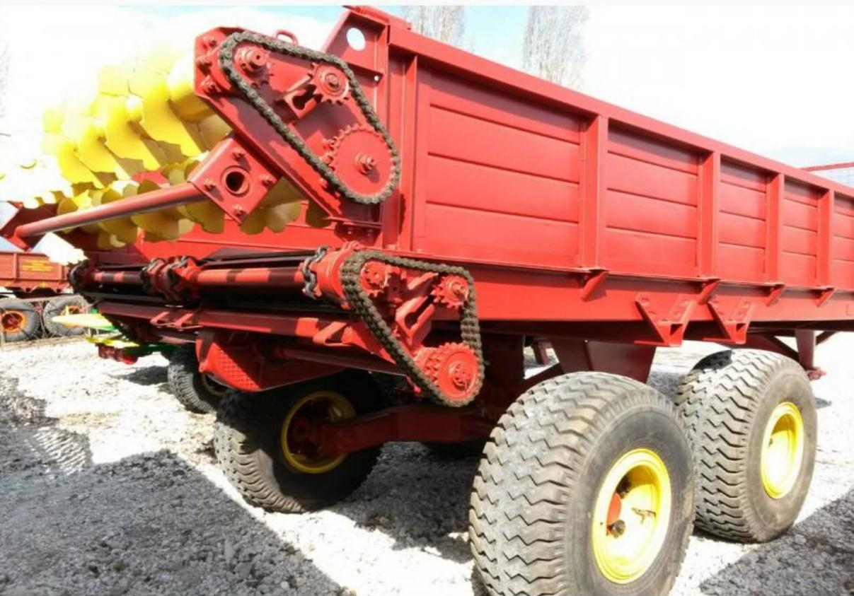
Разбрасыватель компоста TORNADO предназначен для разбрасывания навоза, торфа, компоста и извести. Машина оснащена четырехбарабанным, вертикальным червячным адаптером с режущими ножами, которые обеспечивают высокую степень измельчения и большой диапазон разброса
