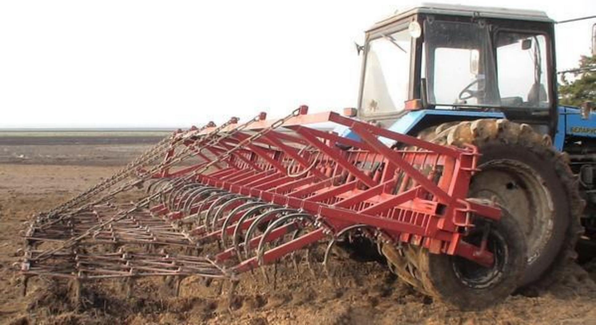
**Культиватор КНС-6,3 (КНС-4,0) предназначен для сплошной предпосевной и паровой обработки всех типов почв с одновременным боронованием с засоренностью камнями не более 60мм.**
