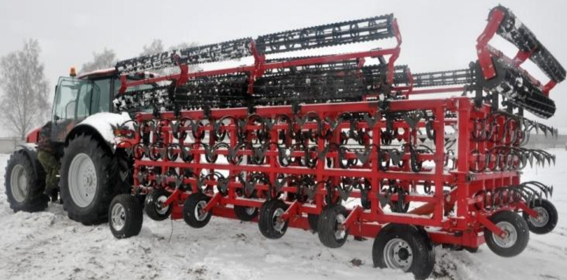
**Предназначен для ранневесеннего закрытия влаги, паровой и предпосевной обработки всех типов минеральных почв, за один проход по полю обеспечивает полную подготовку почвы к посеву, совмещая культивацию, рыхление, выравнивание и предпосевное прикатывание почвы с созданием в посевном слое уплотненного ложа для семян.**
