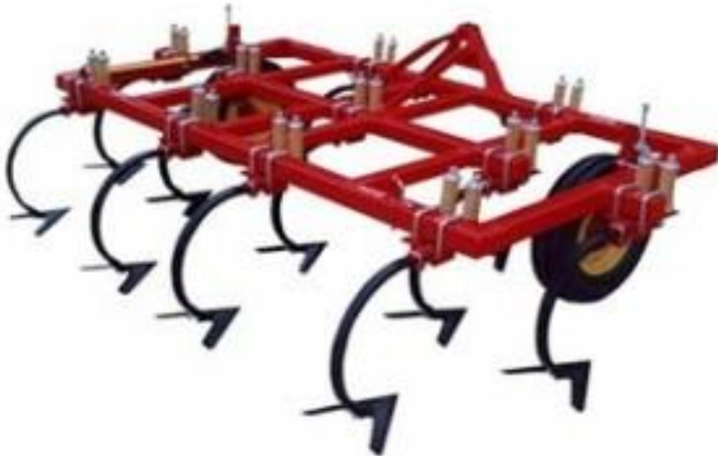
**Предназначен для сплошной предпосевной и осенней обработки почв с сохранением на ее поверхности стерни, защищающей почву от ветровой эрозии**
