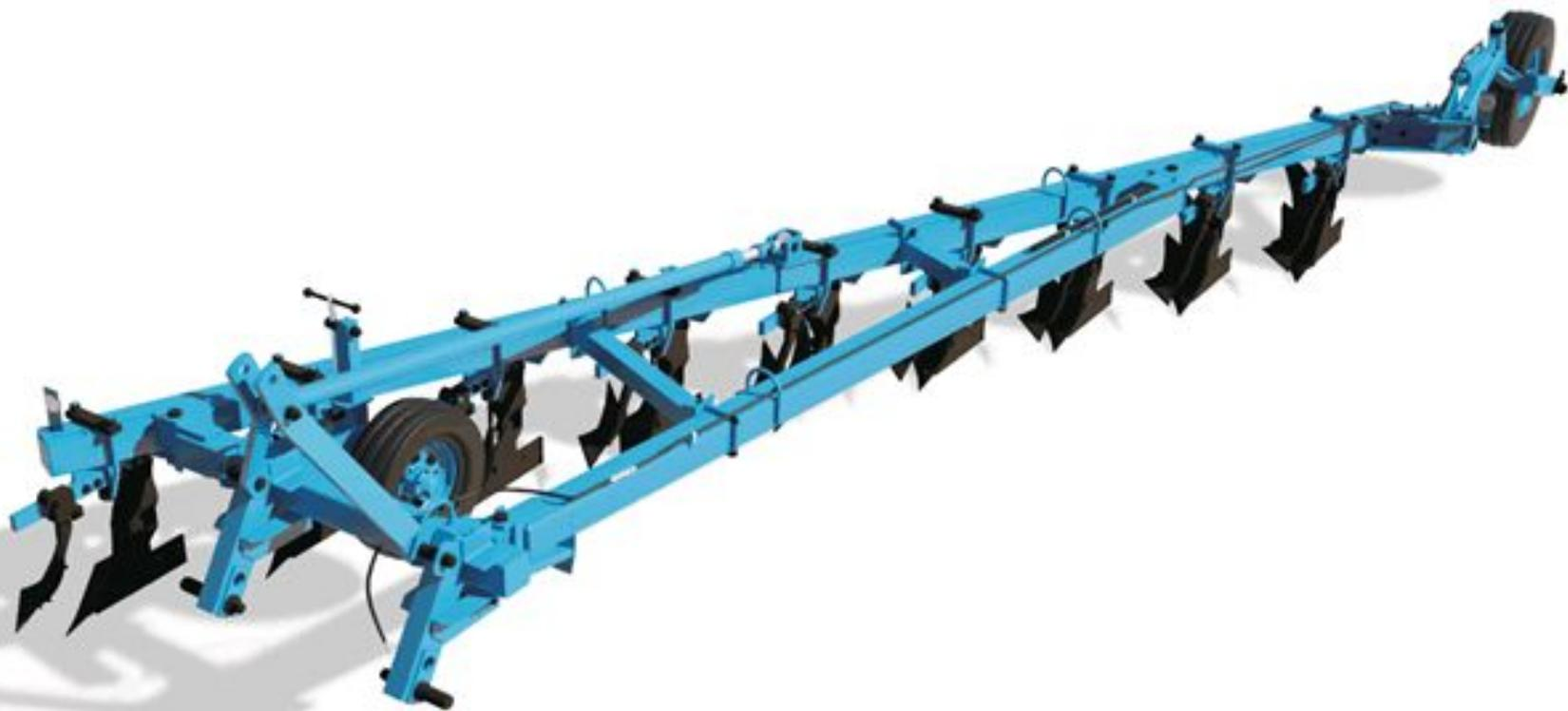
**В плуге ПНП 8-50К использованы оригинальные корпуса с универсальными отвалами шириной захвата 50 см, которые обеспечивают хорошее крошение почвы и оборот пласта. Рабочие органы плуга защищены срезными болтами от поломок; оборудованы углоснимами, которые выполняют функцию предплужников и укладывают пласт почвы на дно борозды.**
