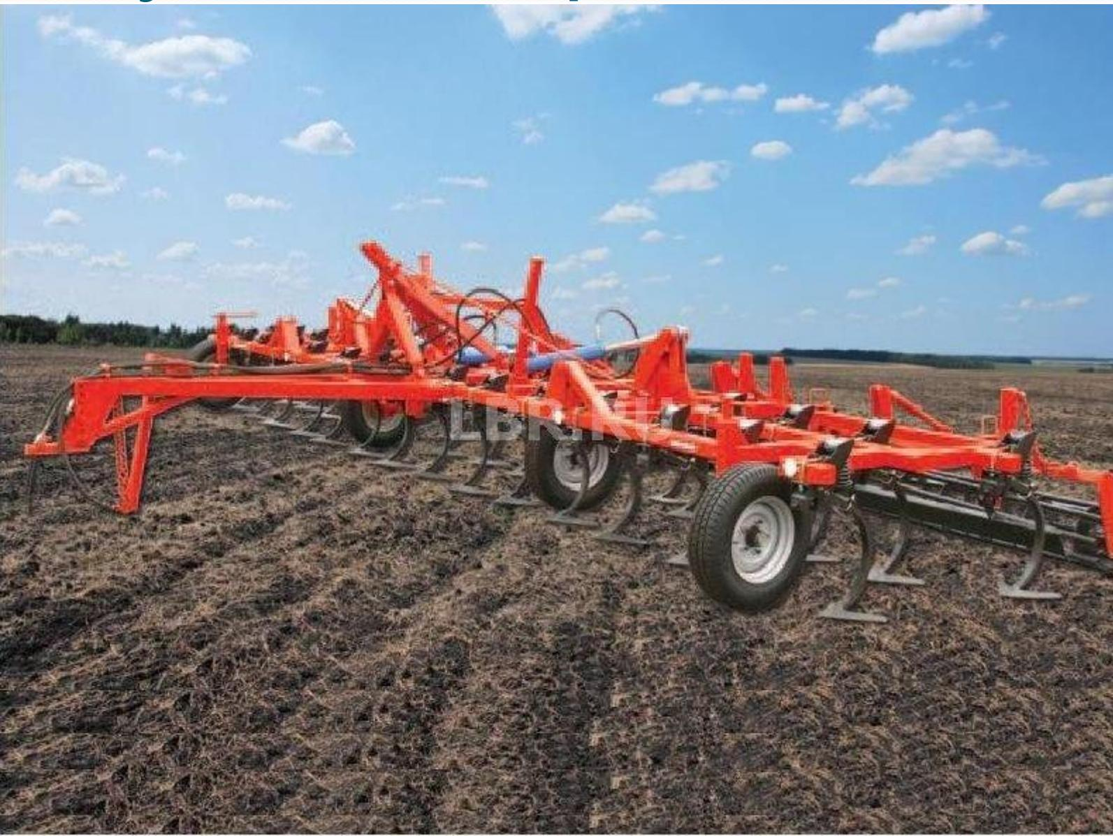
**Культиватор широкозахватный универсальный КШУ 12 предназначен для ресурсосберегающей предпосевной и паровой культивации почвы, подрезания и вычесывания сорняков, а также выравнивания и уплотнения поверхности почвы под посев.**
