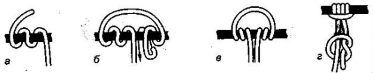
Рис. 70. «Схватывающий» узел одним концом
