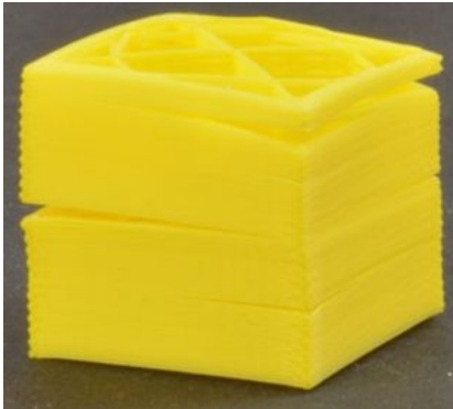
ПЛОХАЯ СВЯЗЬ МЕЖДУ СЛОЯМИ
