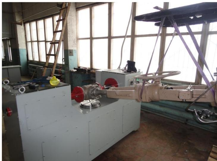
**Проводимые работы: разборка, чистка, дефектация, замена изношенных узлов, сборка, настройка в сборе, проверка герметичности затвора.**
