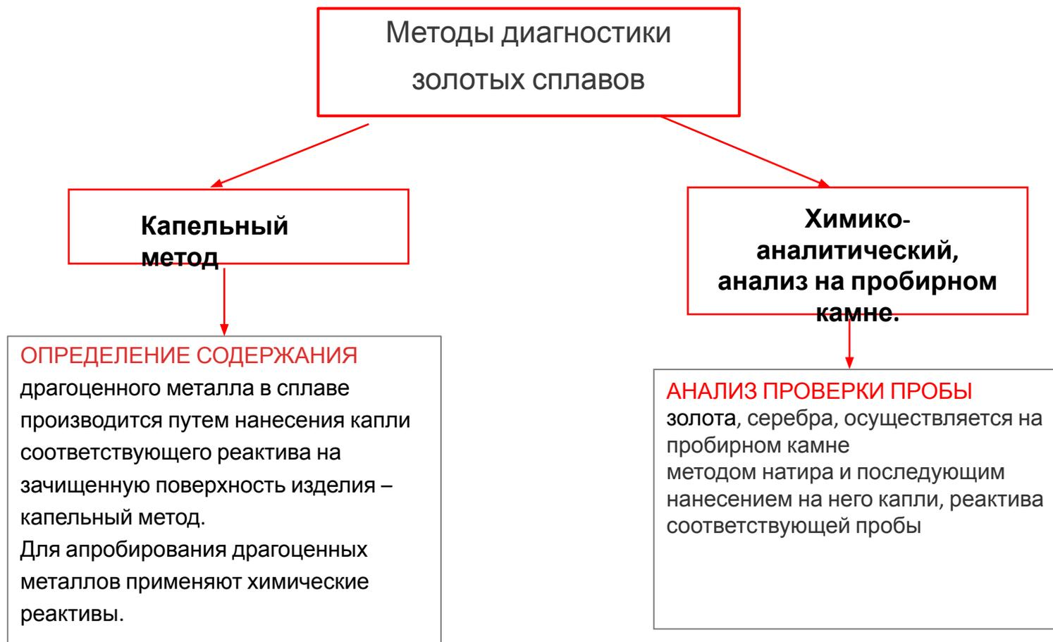
**ПРОБИРНЫЕ РЕАКТИВЫ** – это водные растворы кислот, смесей кислот или растворы солей, с помощью которых опробуют поверхность испытуемого металла.
