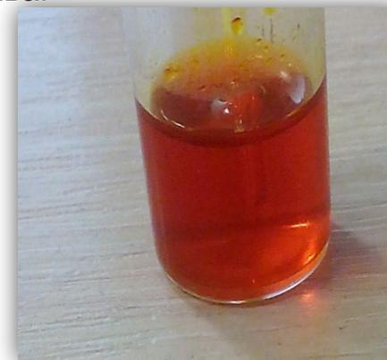
Под действием хромпика серебро 600-й пробы оставляет темный буро-красный осадок. Яркость пятна возрастает с повышением пробы. В пределах 780...820-й проб бурые оттенки исчезают, переходя в оранжевый цвет. С повышением пробы краснота возрастает, серебро 875-й пробы реагирует красным цветом. Яркость красного цвета возрастает, переходя в «кровавый» выше 900-й пробы.
