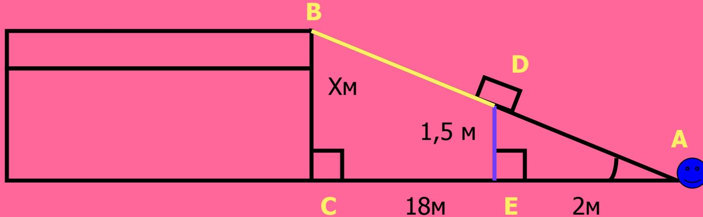
Для того чтобы определить высоту здания ДК «Железнодорожника», мы поставили на некоторое расстояние от здания ДК «Железнодорожника» шест DE с вращающейся планкой и направили планку на верхнюю точку B. Отметим на поверхности земли точку A, в которой прямая BD пересекается с поверхностью земли.
