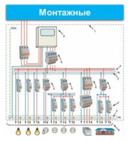
Разработанную монтажную однолинейную схему накладывают на план помещения и по этому документу осуществляют прокладку электропроводки.
