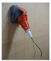
Подготовленные разъёмы соединяется с соответствующими разъёмами ЭУ. К полученным проводникам подключаются электроды мегомметра. Напряжение - 500В.
