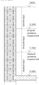
СХЕМА РАЗБИВКИ КИРПИЧНОЙ КЛАДКИ ПО ЯРЦАМ
