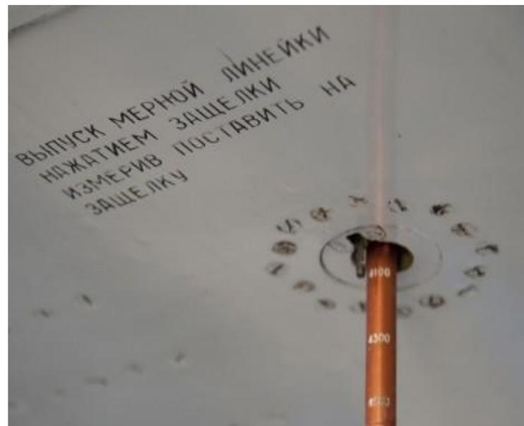
В баке плавают магнит, который подхватывает линейку и не дает ей опуститься ниже уровня керосина. Таким образом, можно без электроники определить заправку бака.
