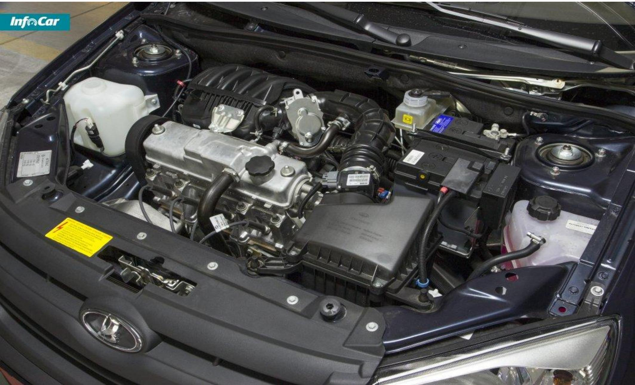
Проверяем состояние проводов, крепления и самих датчиков отвечающих за пуск ДВС и формирование «заряда» - датчики ДМРВ – массового расхода воздуха, ДППГ- датчик положения педали газа, ДПКВ – датчик положения коленвала,
