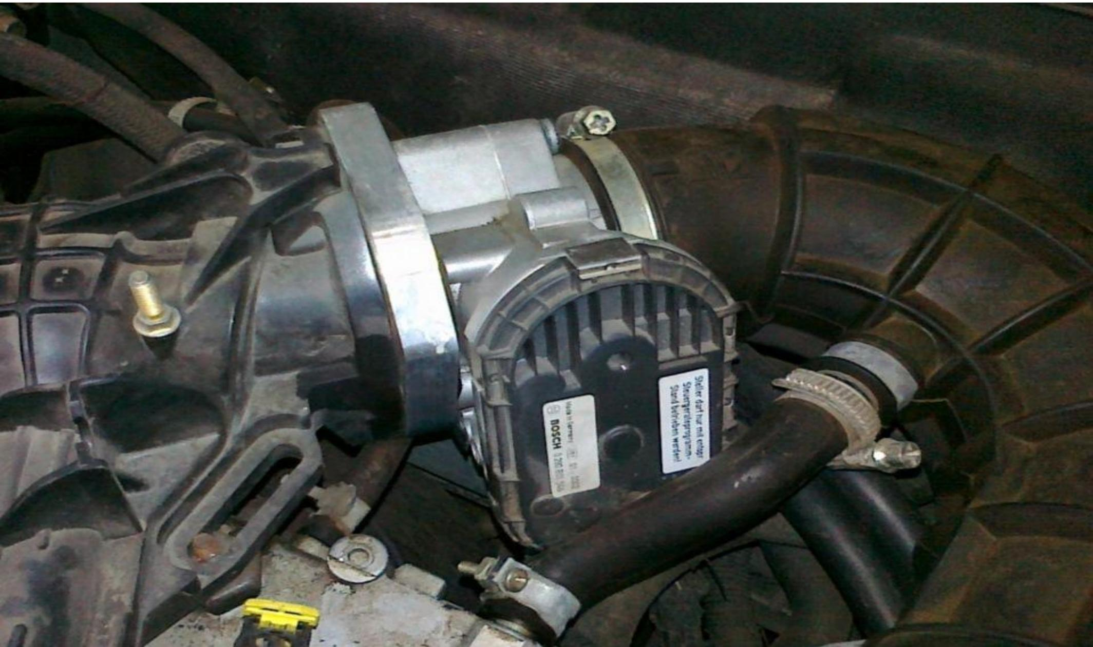
Дроссельную заслонку поворачивает электродвигатель через редактор. Оба
