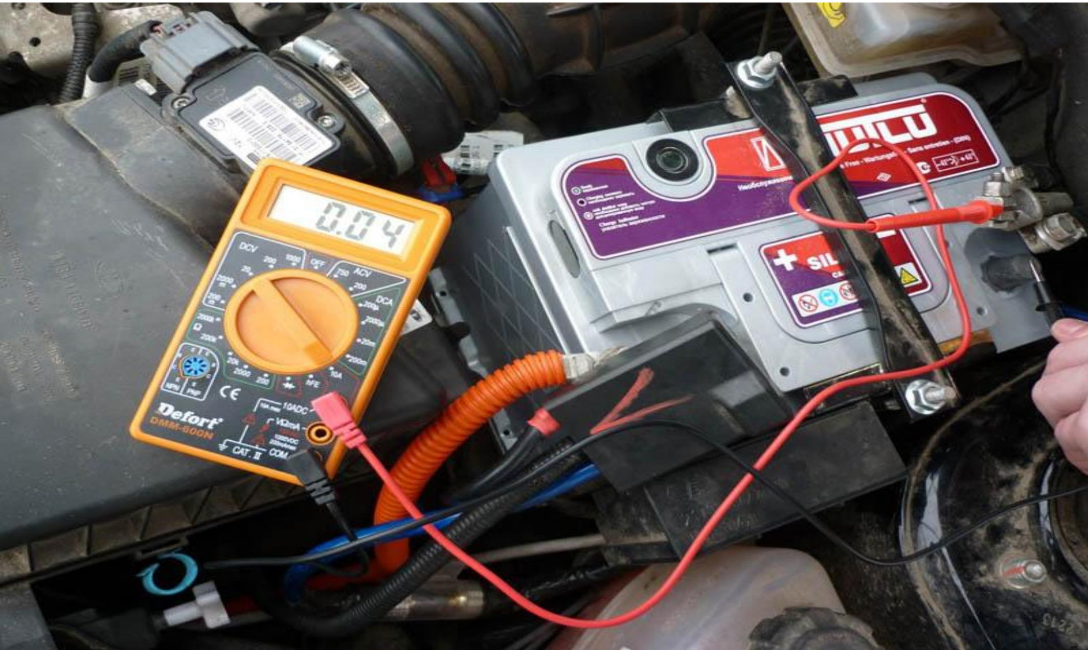
*При техническом обслуживании аккумуляторных батарей проверяют чистоту клемм и крышки, отсутствие трещин на корпусе, отсутствие окислов на клеммах, уровень и плотность электролита, а также степень заряженности.*
