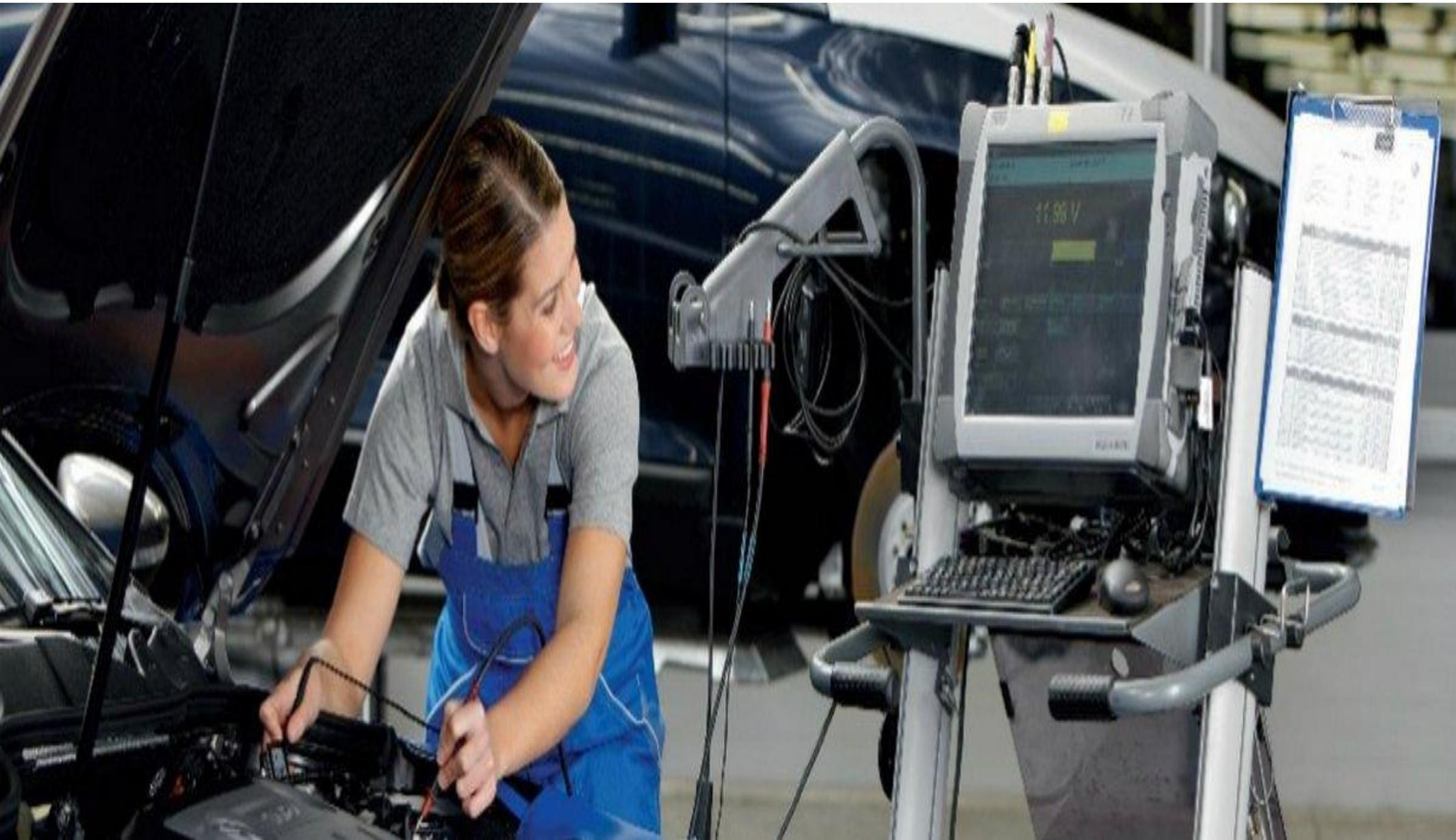
Рабочее место поста диагностики оборудовано: подъемником, набором инструментов, измерительным инструментом, динамометрическими ключами, технической литературой, в которой есть необходимая информация по выполнению работ,
