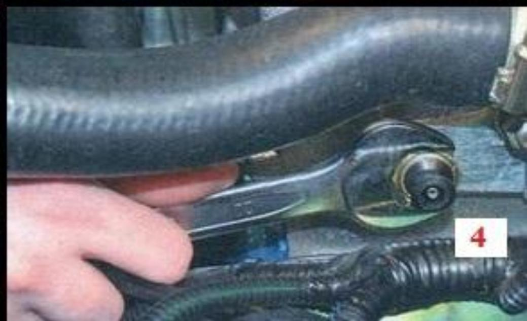
Осматриваем состояние датчика –**ТОЖ** температуры охлаждающей жидкости, исправность датчика может быть проверена мультиметром или сканером при диагностике всей системы управления двигателя
