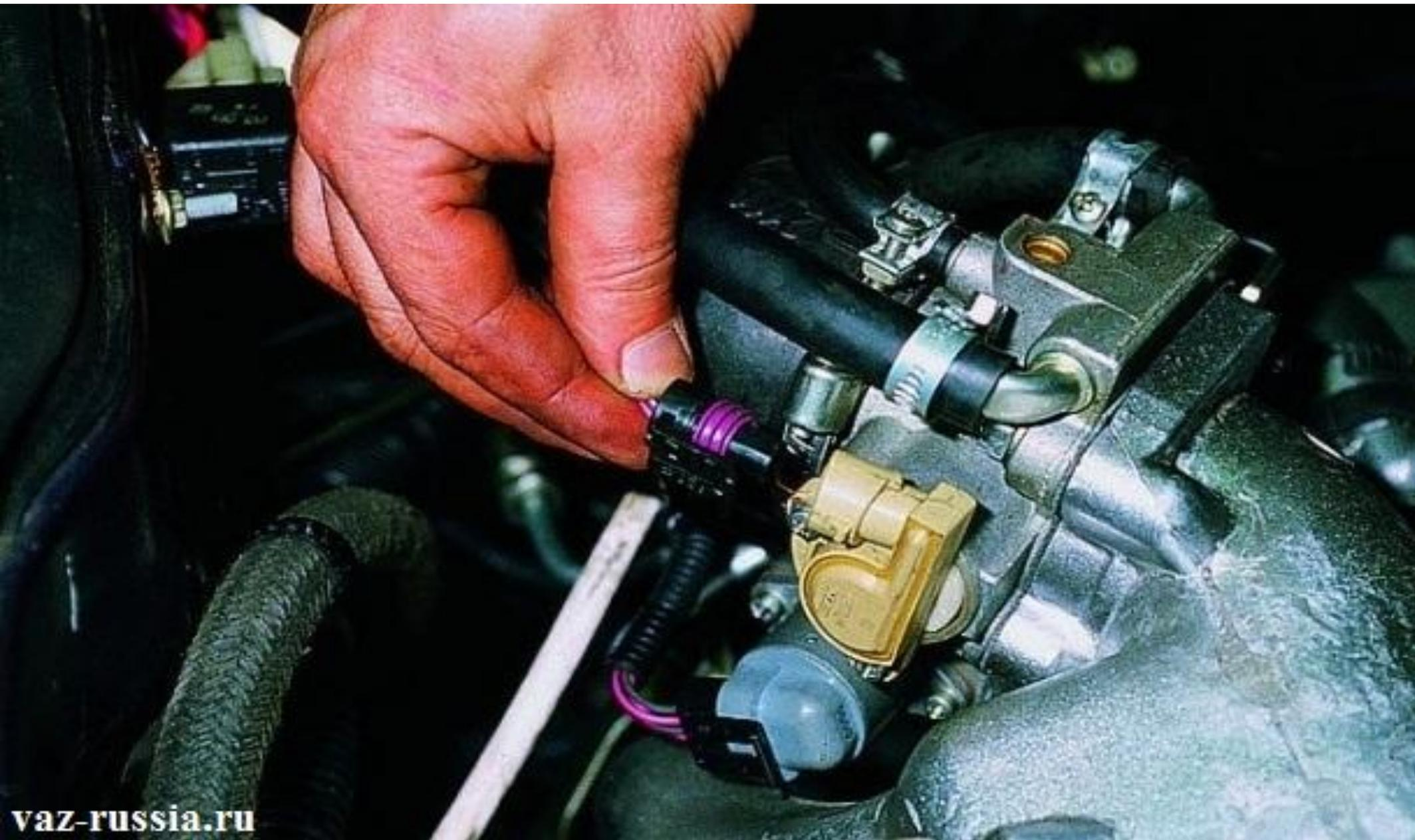
Проверяем 3) плотность соединения и целостность патрубков дроссельного узла
