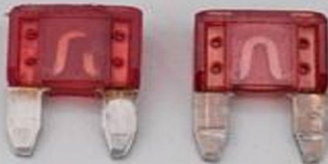
Достаем предохранители пинцетом или щипцами и проверяем их мультиметром, включив мультиметр вы ставите режим «измерение» сопротивления и присоединяете контакты для измерения величины «сопротивления» предохранителя
