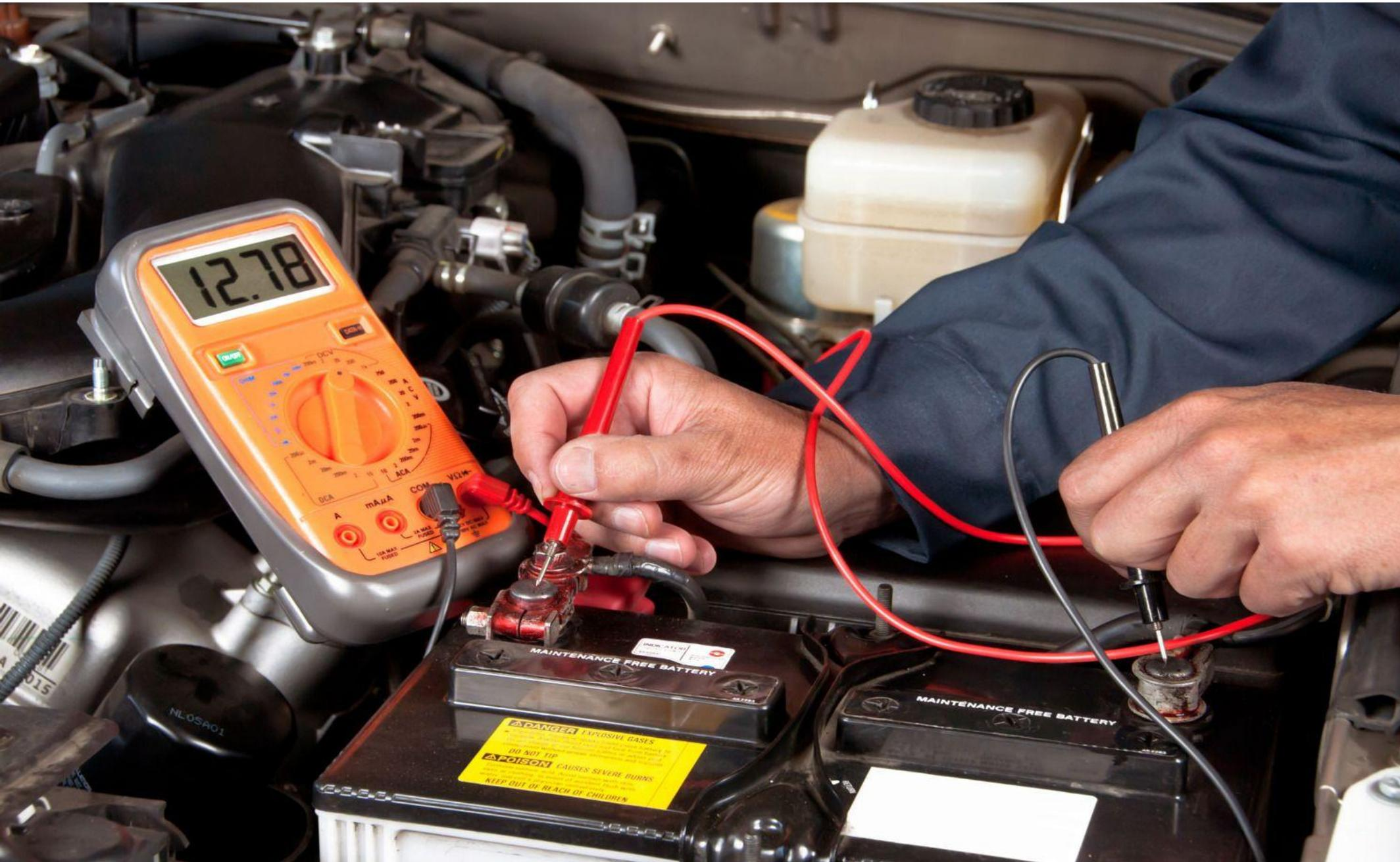
Для диагностирования АКБ необходимо иметь: нагрузочную вилку, мультиметр и ареометр, для работы с обслуживаемыми АКБ
