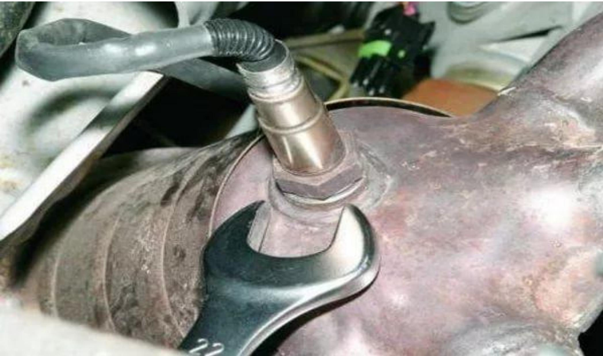
Проверяем состояние проводов, крепления и самих датчиков отвечающих за контроль работы двигателя датчиков кислорода - «лямбда зонда» второй датчик стоит на выпускной трубе
