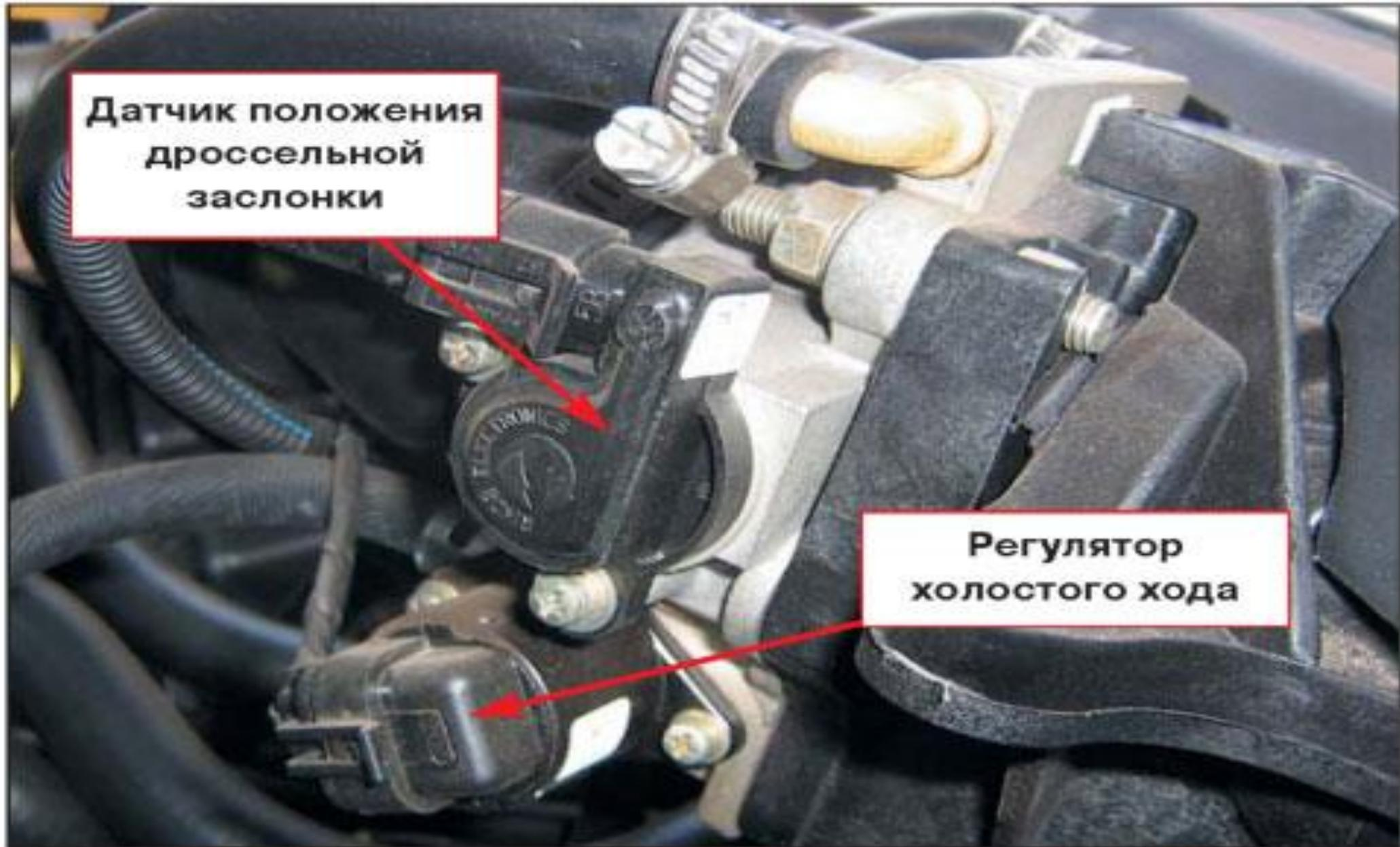
Исправность датчиков дроссельного узла можно установить тестером при сканировании неисправностей системы управления двигателем
