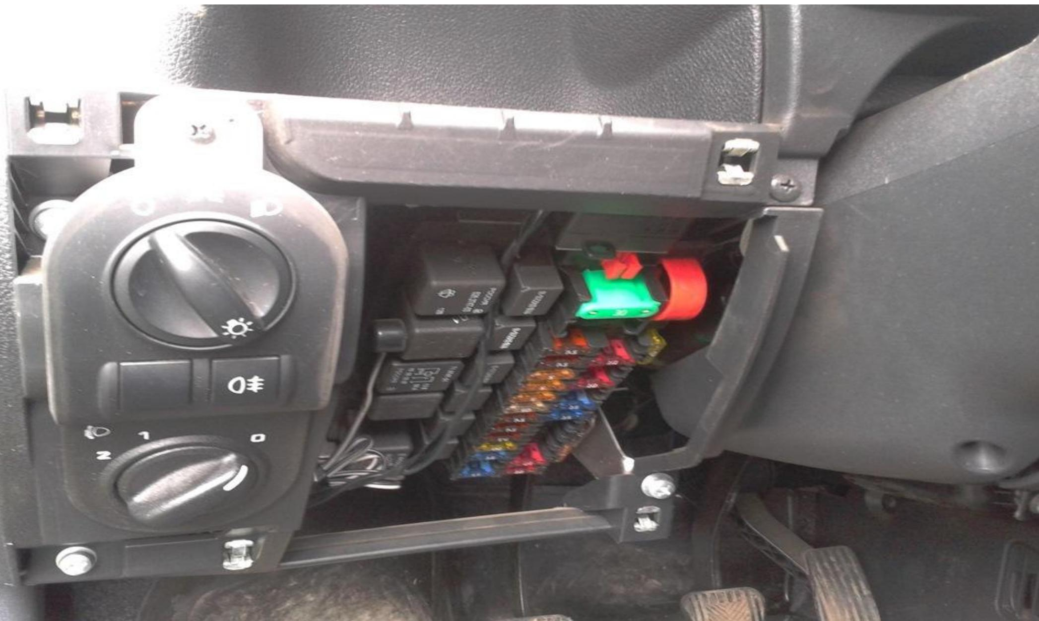
Для пуска двигателя необходимо **проверить два предохранителя отвечающие за подачу топлива и зажигания** это первый предохранитель - F21-15А (А-ампер – сила тока) подает ток на топливный насос и второй предохранитель - F22-15А (А-ампер – сила тока) подает ток на блок управления центрального замка (замка зажигания)
