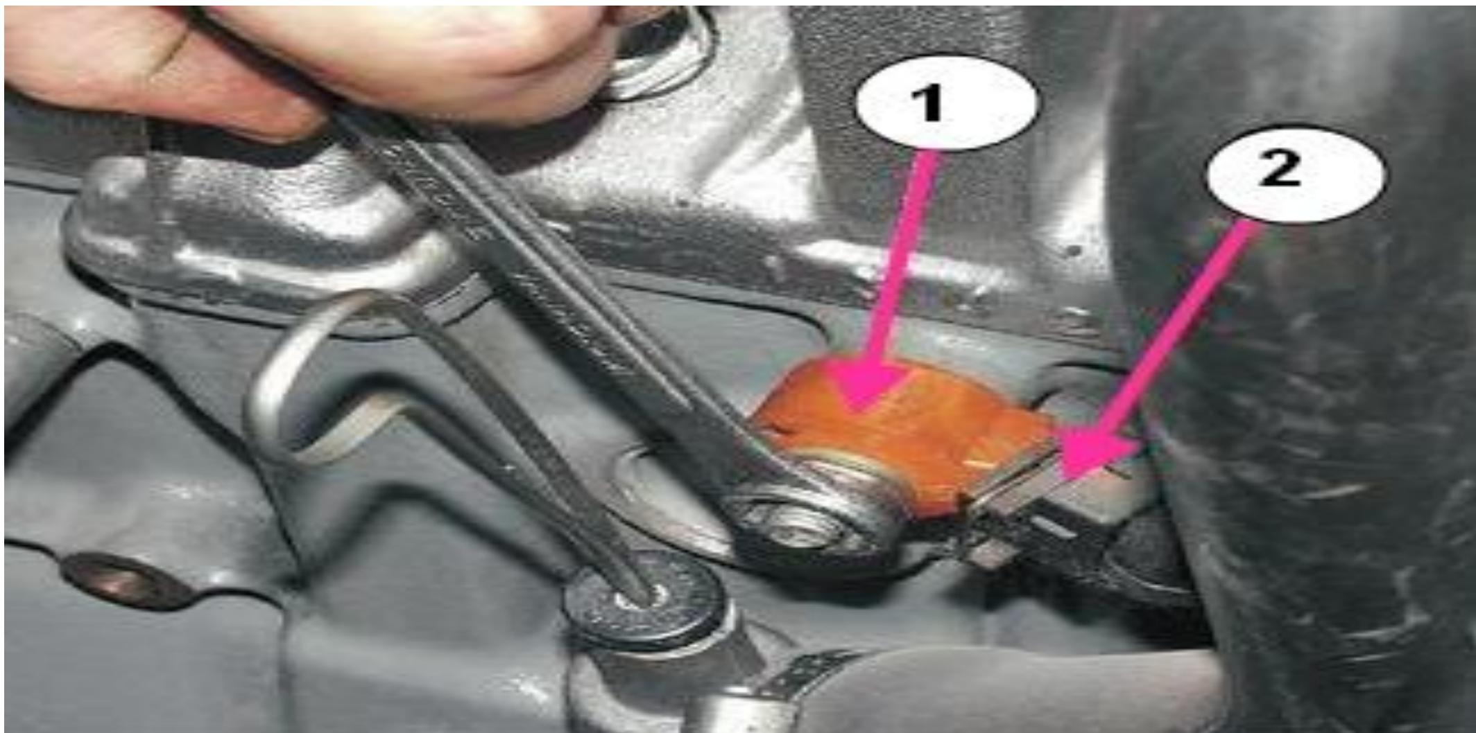
1 - датчик детонации, 2 - разъем датчика
