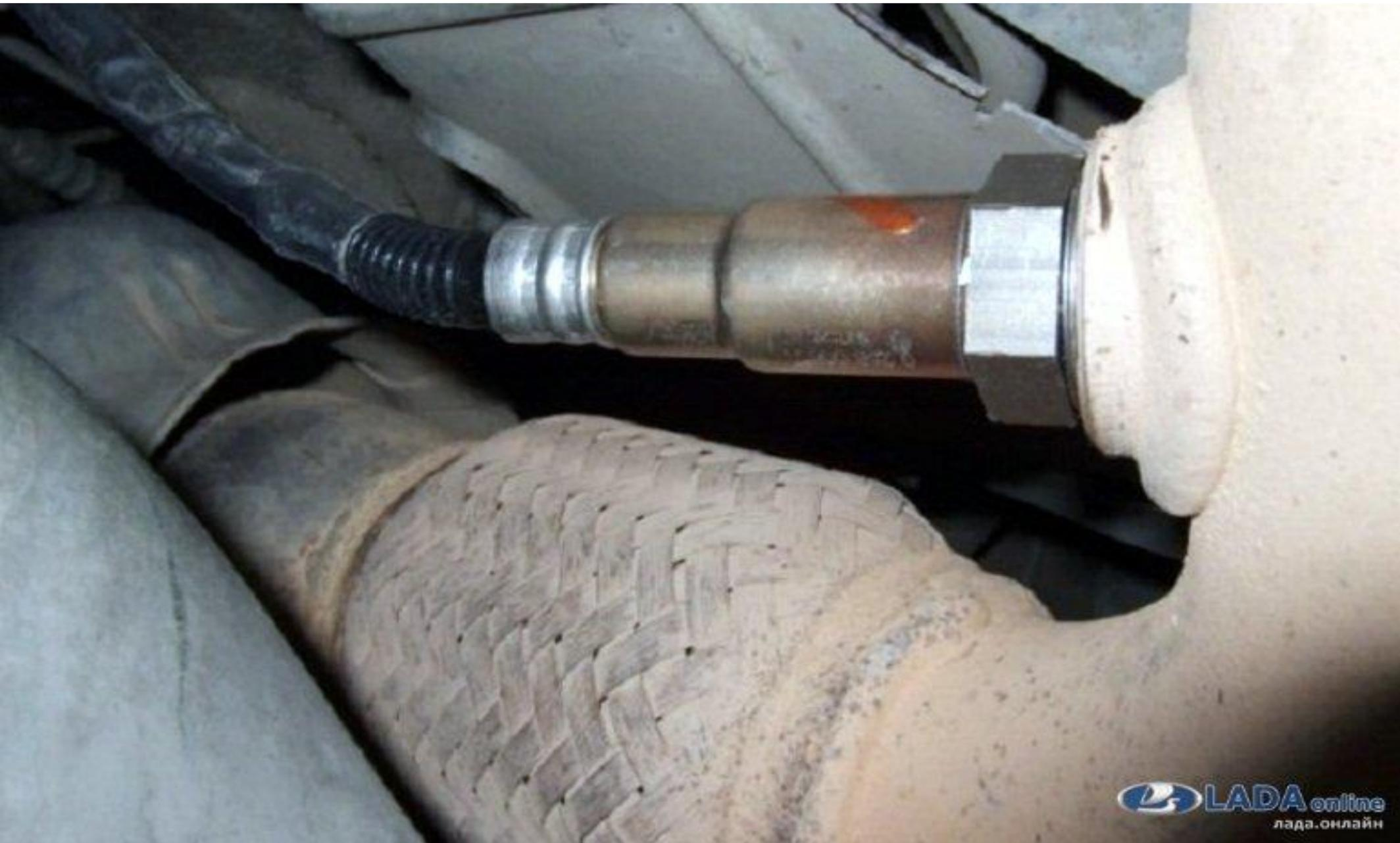
Проверяем состояние проводов, крепления и самих датчиков отвечающих за контроль работы двигателя, т.е датчиков температуры
