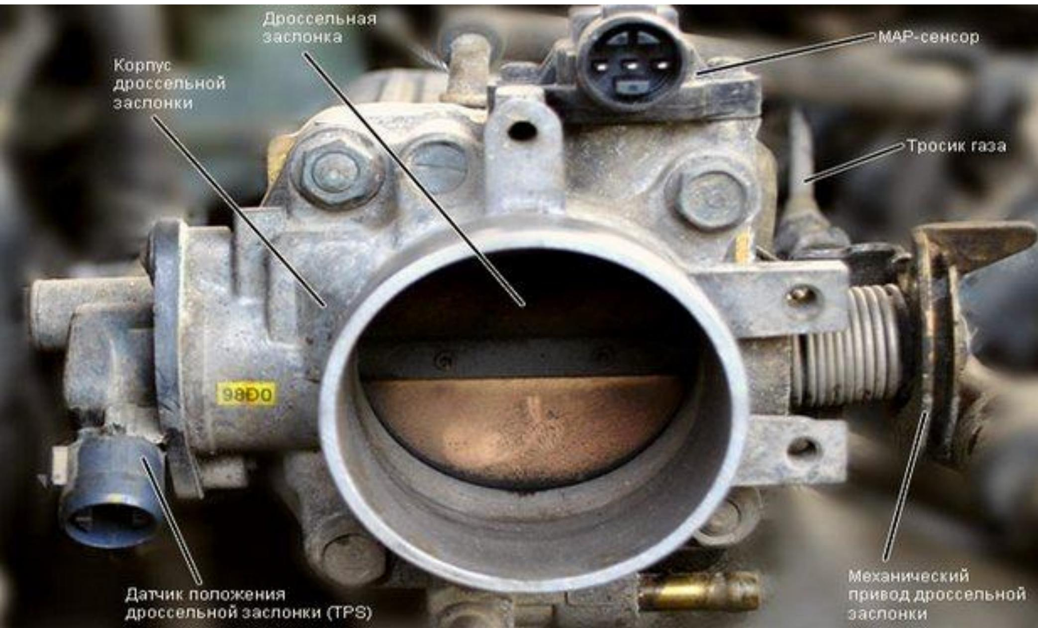
Проверяем 1) окисление контактов в колодке датчиков
