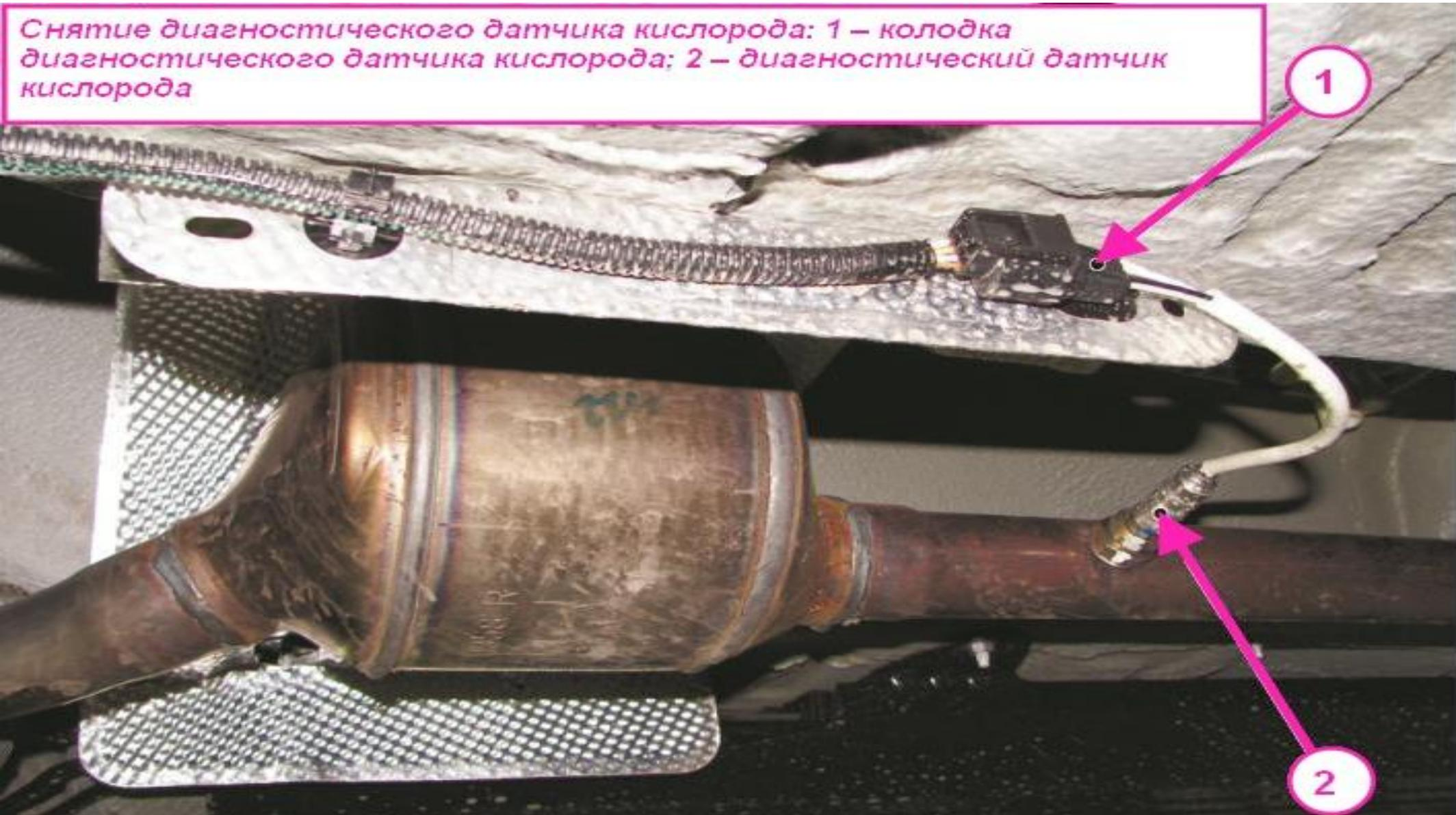
Проверяем состояние проводов, крепления и самих датчиков **КИСЛОРОДА**
