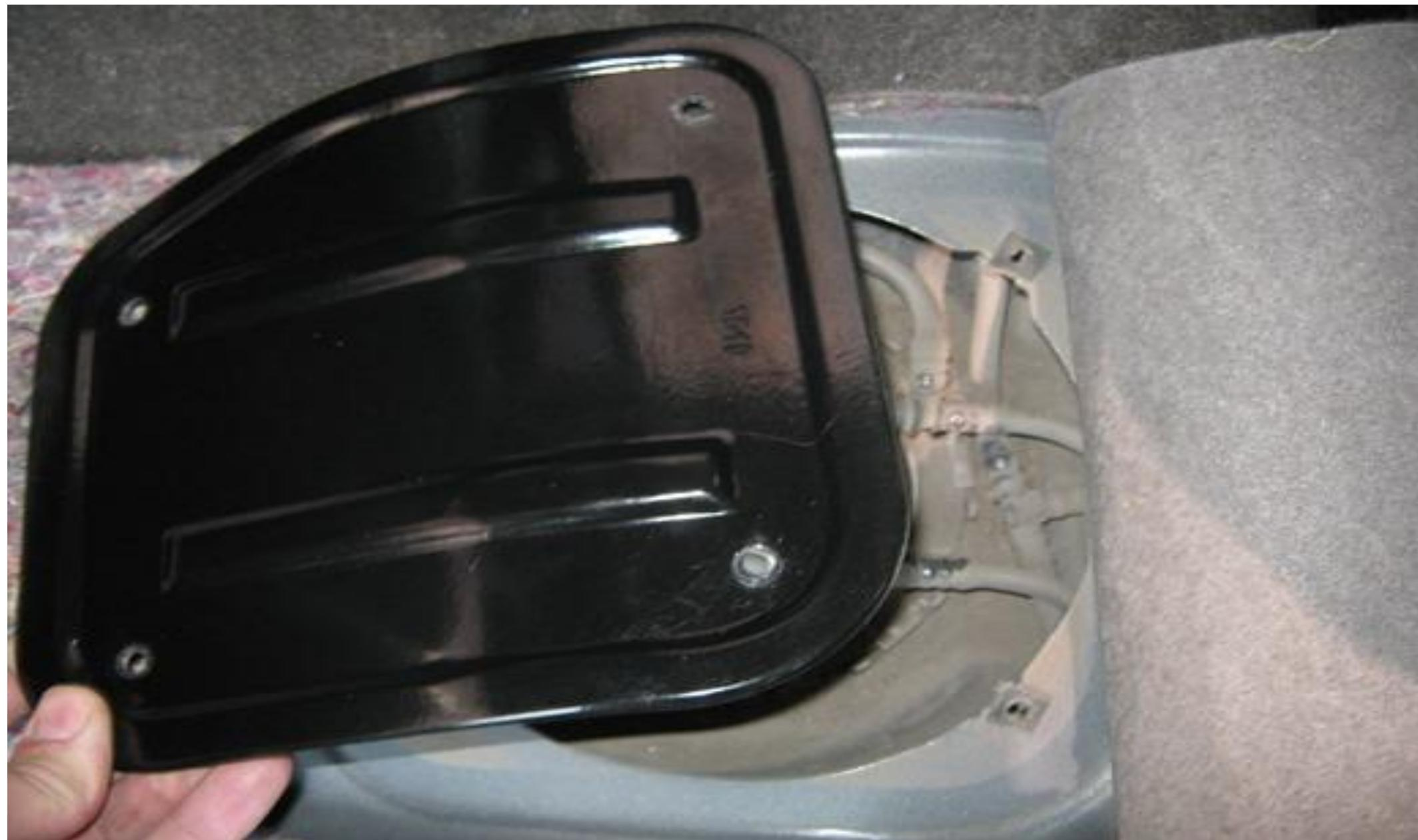
Проверить состояние проводов и креплений контактных колодок топливного насоса и указателя уровня топлива
