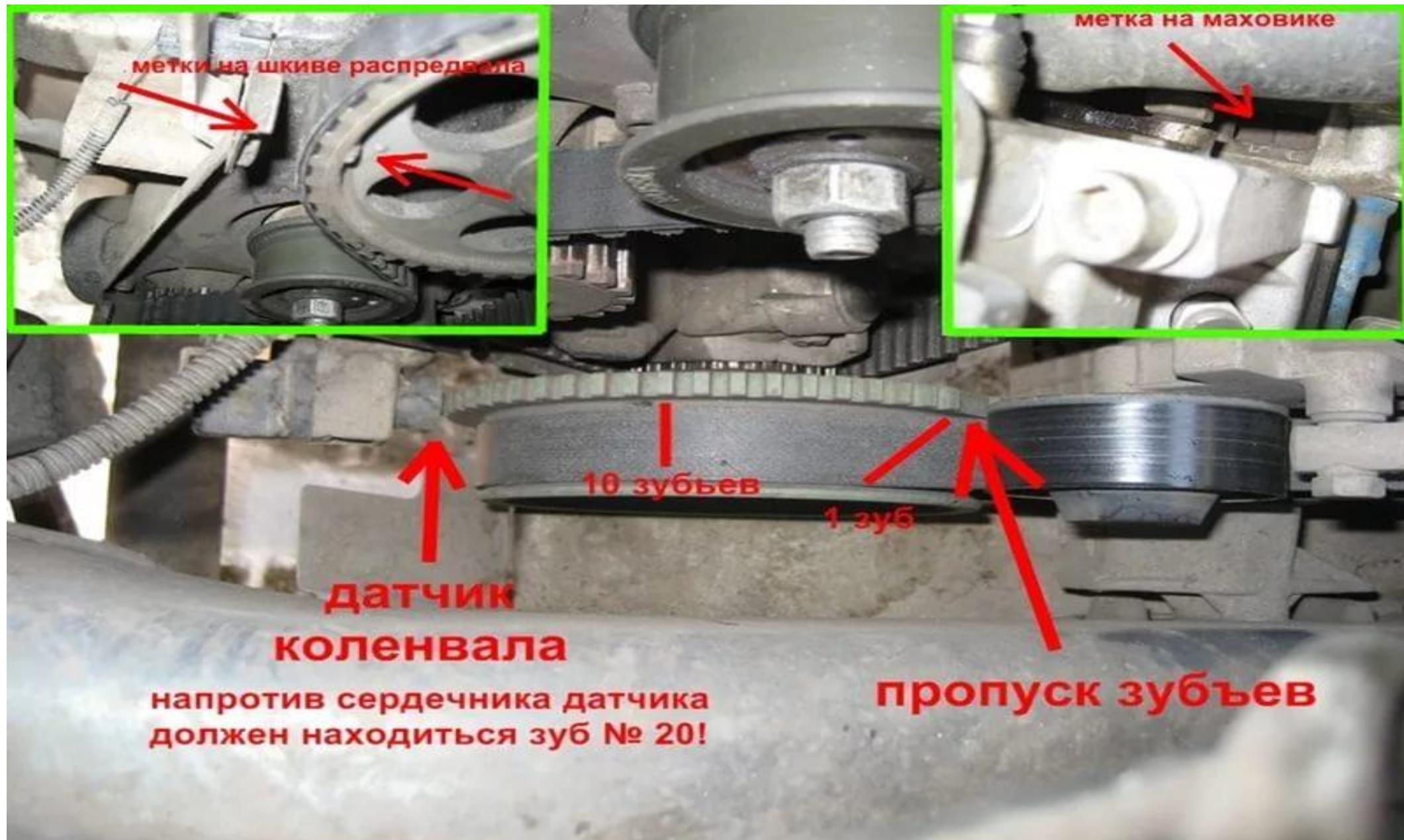
Осматриваем состояние датчика – **ДПКВ** — датчика положения коленчатого вала , исправность датчика может быть проверена мультиметром или сканером при диагностике всей системы управления двигателя
