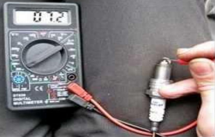
Но проверять свечи на наличие «пробоя» по микротрещинам под давлением нужно специализированным прибором
