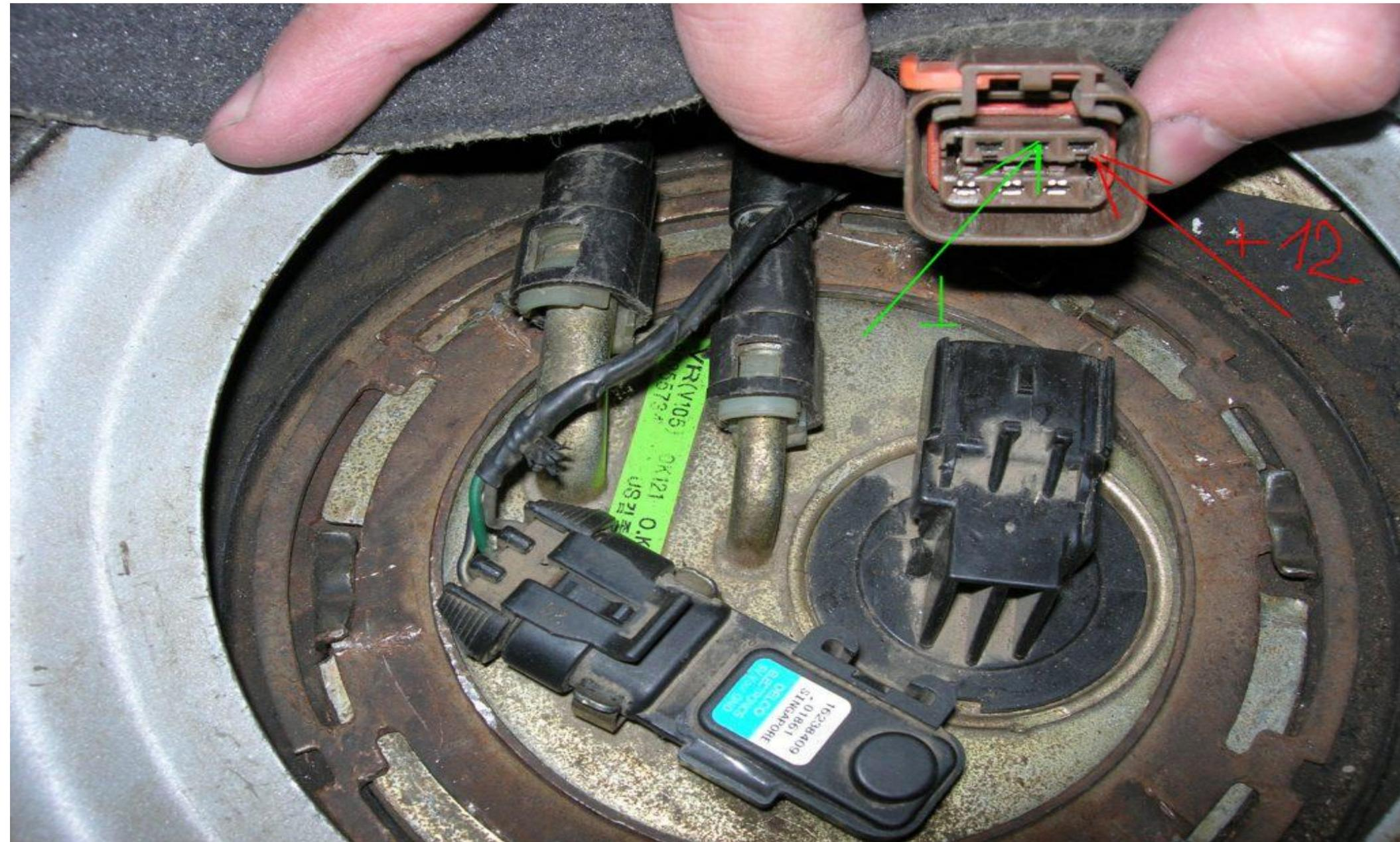
Проверяем состояние проводов, креплений контактных клемм, а так же тестером, подачу напряжения на топливный насос (при включенном зажигании и исправном реле (К-12) и предохранителе ( F-21)
