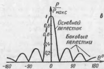
Рис. 2. Диаграмма направленности антенны в полярной (а) и прямоугольной (б, в) системах координат
