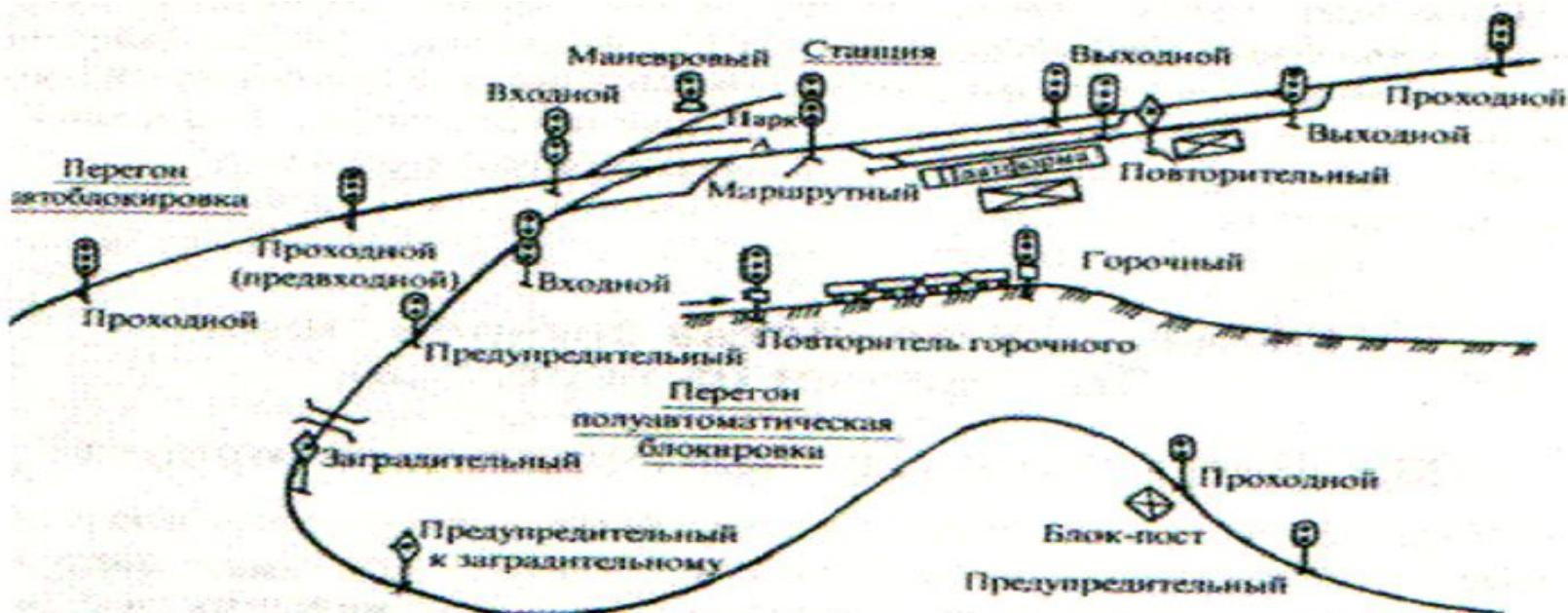
Предупредительные светофоры не устанавливаются перед входными светофорами с неправильного железнодорожного пути и перед входными светофорами на участках, где автоматическая локомотивная сигнализация применяется как самостоятельное средство сигнализации и технологической электросвязи.
