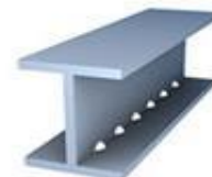
Сборка балки на прихватки
