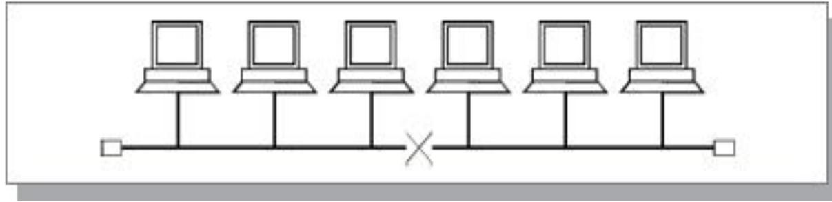
**Рис. 3.5.** Обрыв кабеля в сети с топологией
