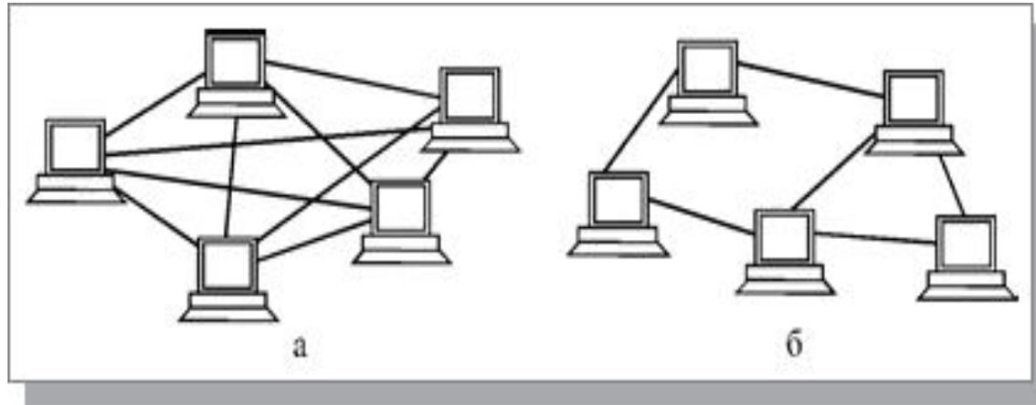
**Рис. 3.13.** Сеточная топология: полная (а) и частичная (б)
