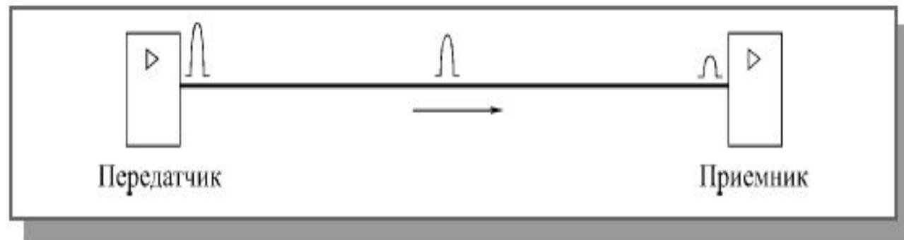
**Рис. 3.4.** Затухание сигнала при распространении по сети
