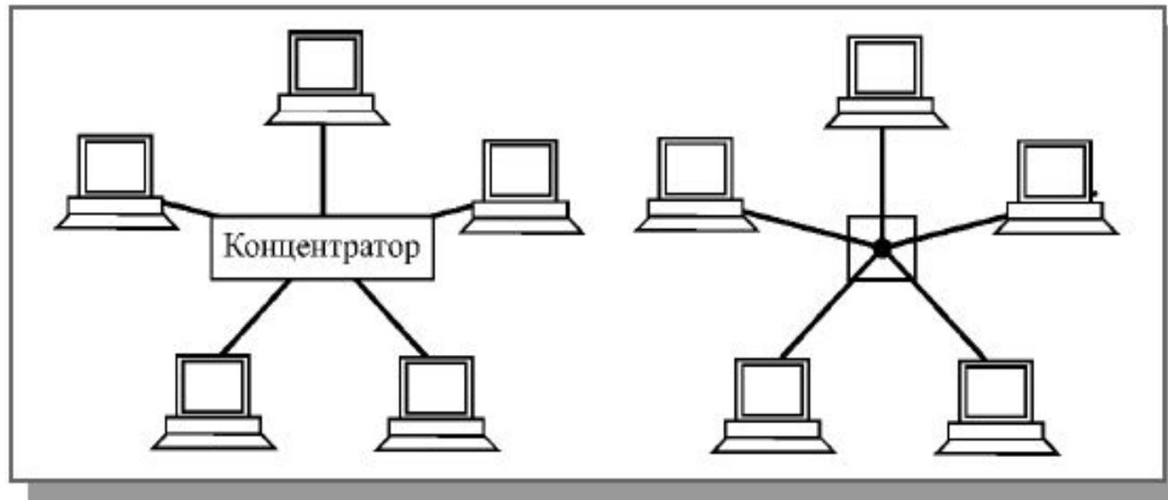
**Рис. 3.7.** Топология пассивная звезда и ее эквивалентная схема
