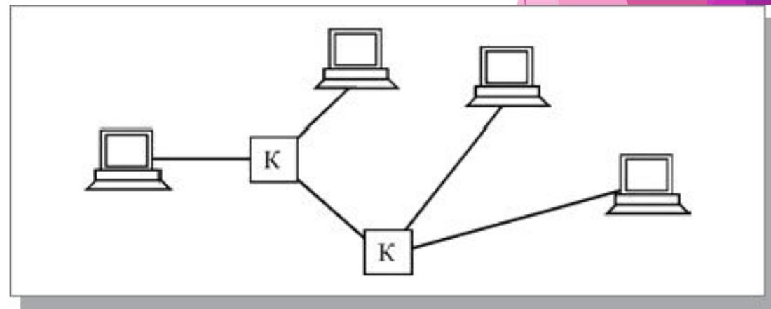
Рис. 3.10. Топология пассивное дерево. К — концентраторы
