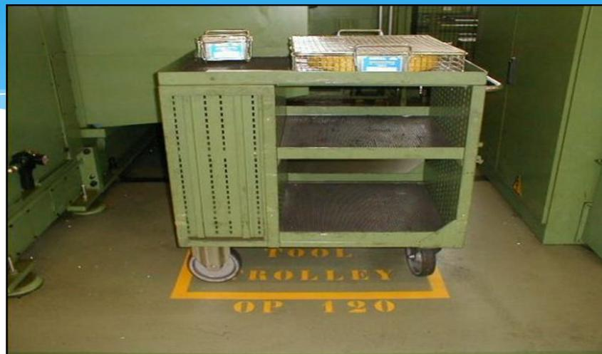
Элементы визуального контроля дают информацию, и/или обеспечивают возможность контроля процесса на рабочем месте таким образом, чтобы все операции выполнялись в соответствии со стандартом.
