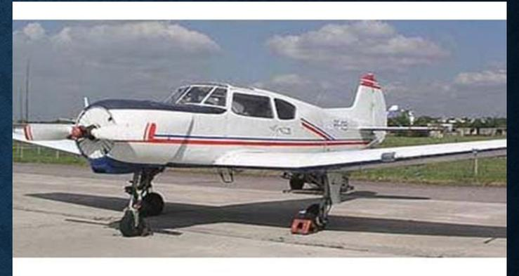
**Ферменно-балочное** шасси состоит из одной (одностоечное) или двух (двухстоечное) консольных балок, подкрепленных подкосами. Установка подкосов разгружает стойку от изгибающих моментов, боковой подкос - от момента, создаваемого боковой силой, а передний или задний - от действия момента силы, направленной вдоль оси самолета. На самолете она обычно крепится при помощи траверсы, выполненной в виде балки, жестко заделанной на стойке (Пе-2, ИЛ-18, Ту-144)
