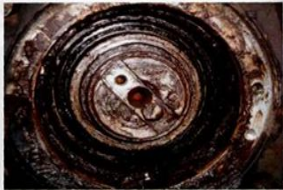
Разрушение торцевого крепления торцевой гайкой M10,
