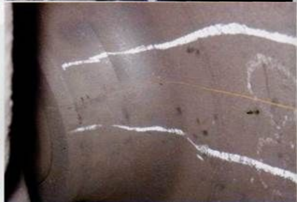
Продольная трещина обода копеса
