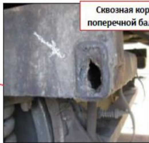
Коррозия продольной балки тележки в районе расположения фановой трубы
