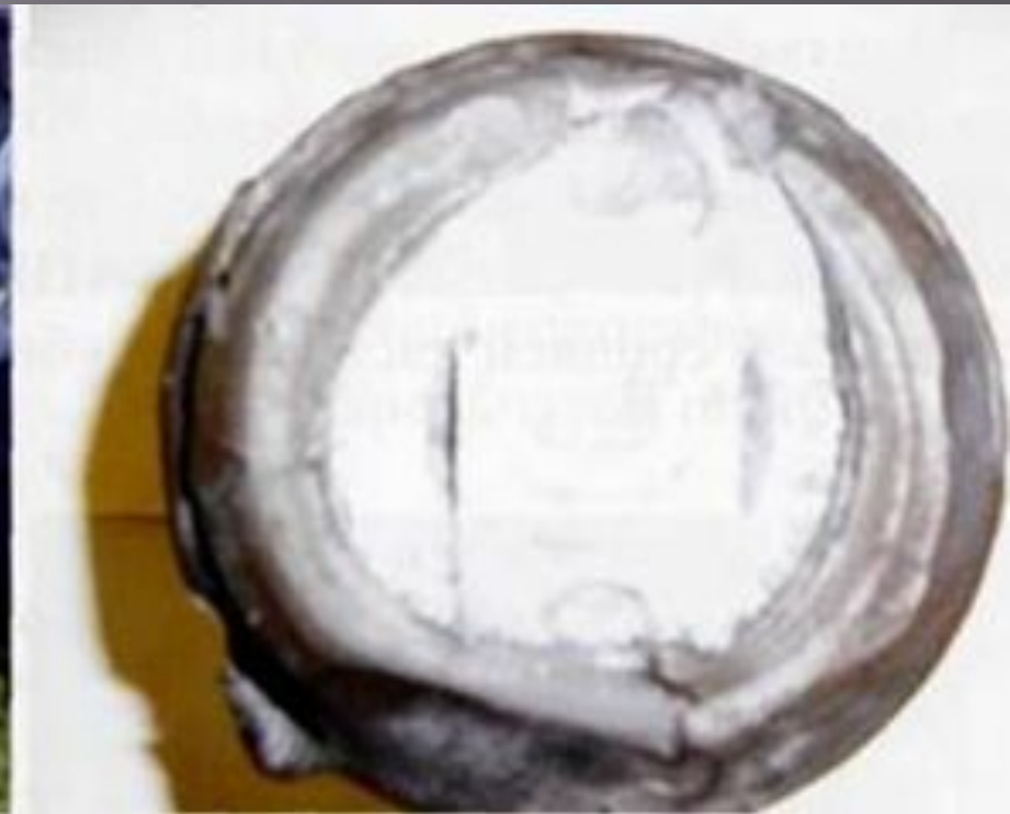
Излом шейки оси от перегрева
