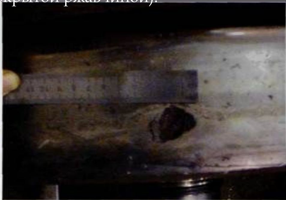
Выщербина с трещиной, идущей в глубь металла
