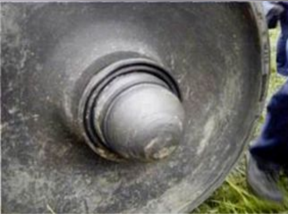
Излом шейки оси от перегрева
