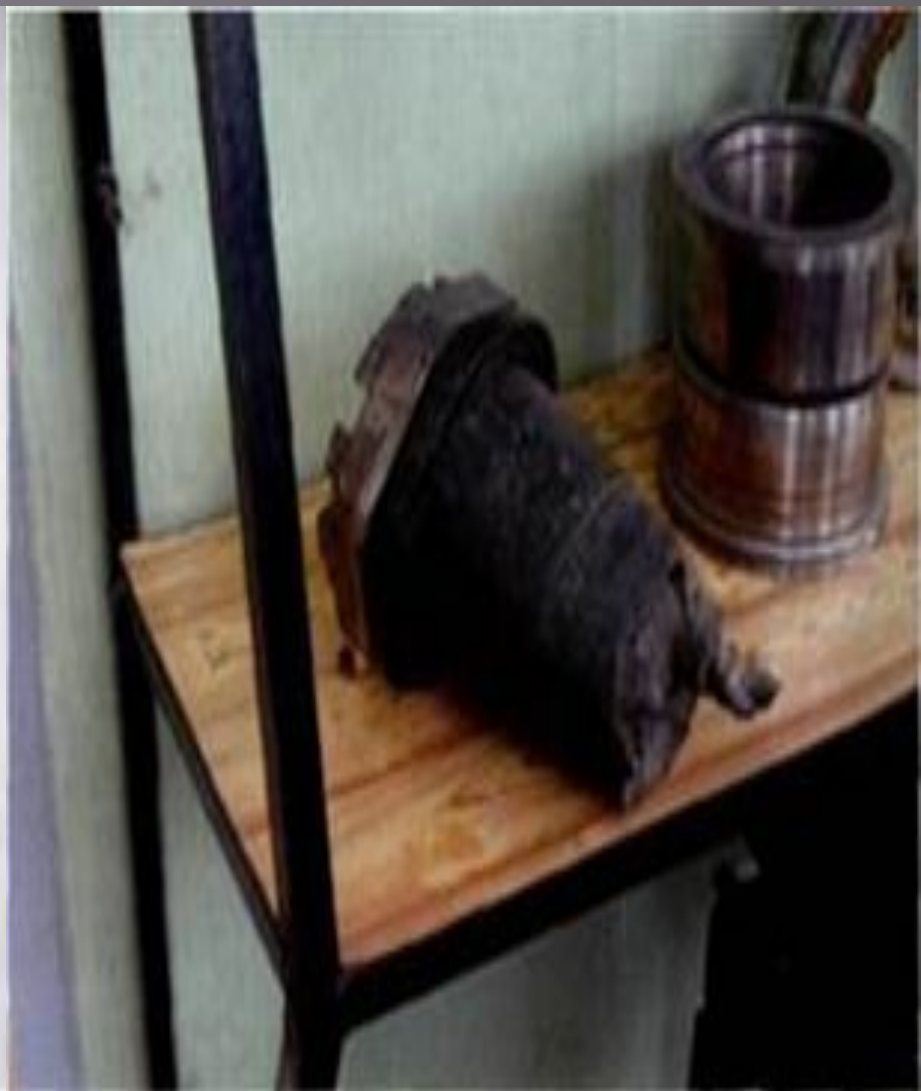
Фрагмент шейки оси после излома
