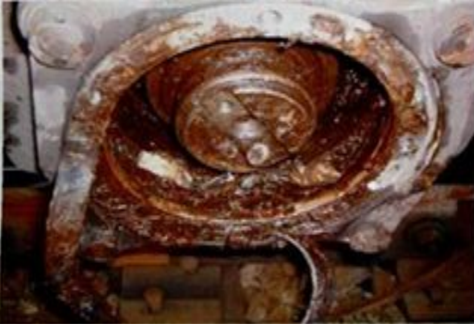
Разрушение торцевого крепления торцевой гайкой M10,
