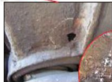
Сквозная коррозия усиливающей пластины наддрессорной балки тележки
