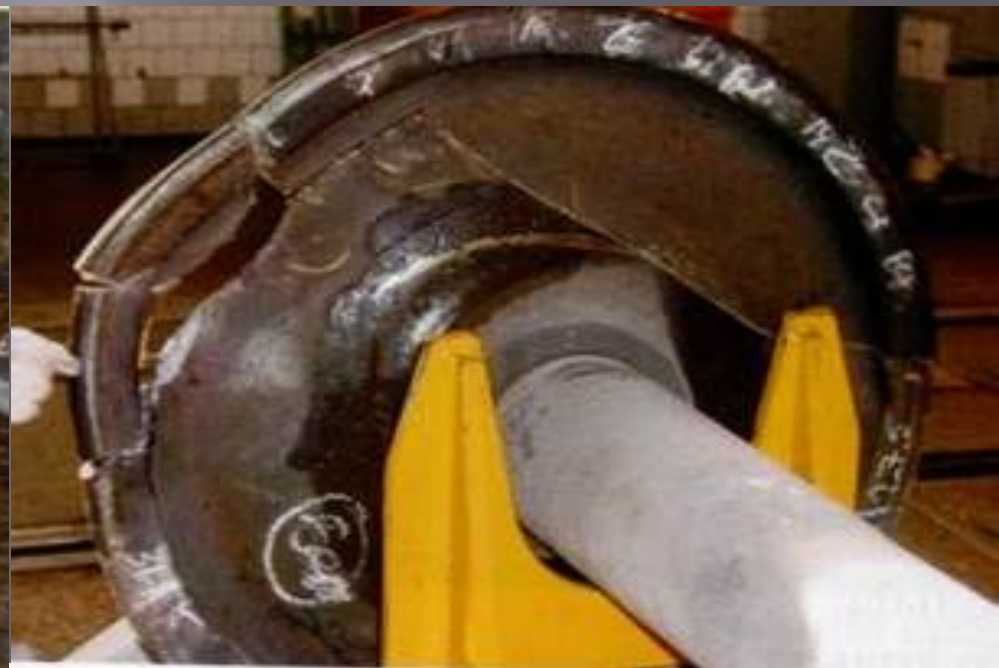
Излом колеса грузового вагона (фрагменты)
