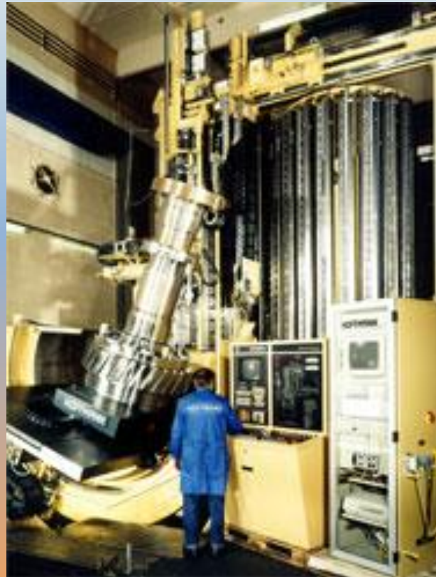
Специализированный вертикальный протяжной станок фирмы Hoffmann-Lapointe
