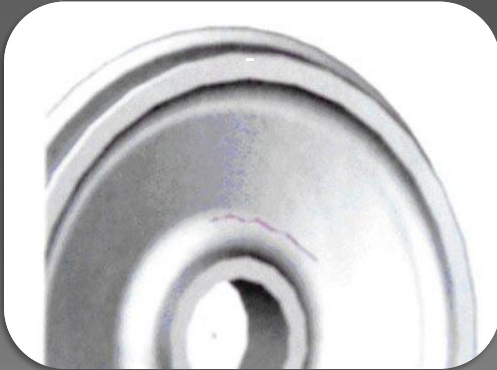
Трещина в диске около ступицы
