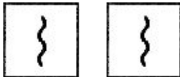
Несколько процессов, по одному потоку в процессе
