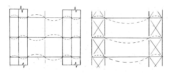
Устойчивость фермы из ее плоскости обеспечивается элементами конструкций покрытия и связями по верхним и нижним поясам. На верхний пояс укладывают прогоны или крупнопанельные плиты покрытия, которые крепят к поясу. В коньке фермы устанавливают связевую распорку, которая обеспечивает устойчивость фермы при монтаже и служит опорой фермы из плоскости при наличии фонаря. Нижний пояс фермы развязывается системой связей по нижним поясам.
