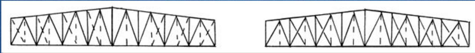
Усиление конструкции от действия монтажных нагрузок.
