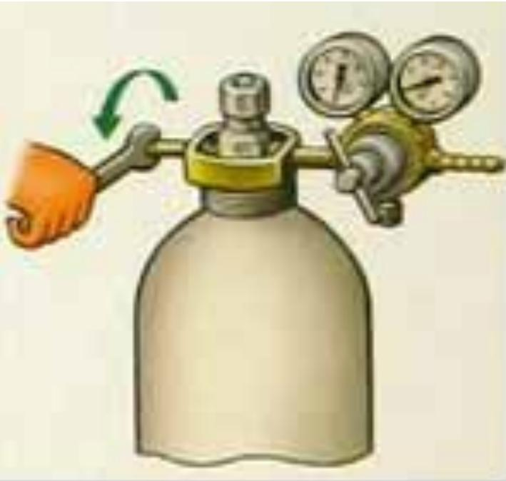
При присоединении ацетиленового редуктора
