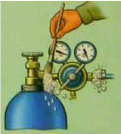
Проверяйте возможные места утечки газа мыльной эмульсией.
