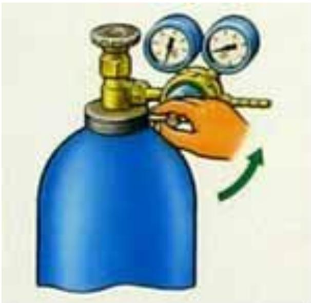
Вывернуть регулировочный винт до полного освобождения нажимной пружины.
