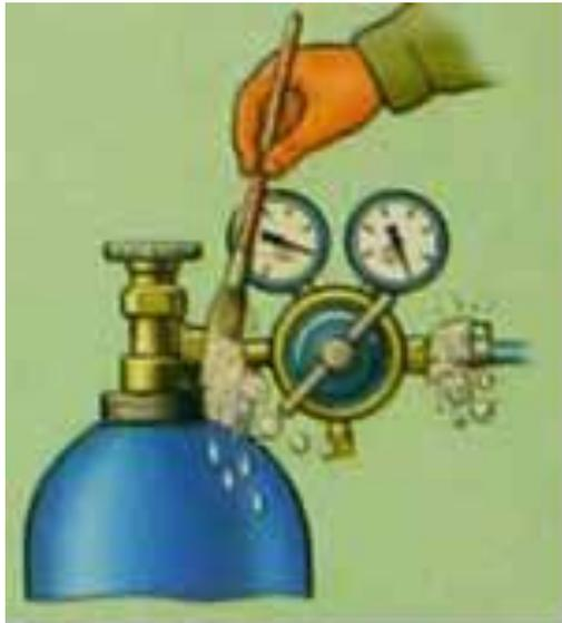
Проверяйте возможные места утечки газа мыльной эмульсией.
