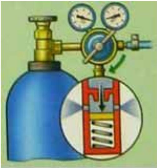
Не реже 1 раза в квартал проверяйте предохранительный клапан принудительным открыванием (подъемом давления до его срабатывания).
