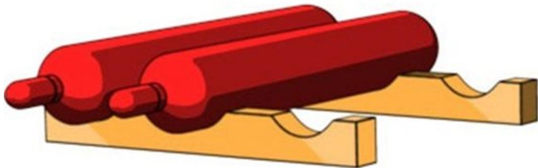
Баллоны, которые не имеют башмаков, могут храниться в горизонтальном положении на деревянных рамах или стеллажах
