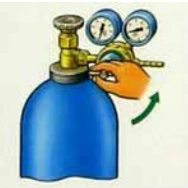
Вывернуть регулировочный винт до полного
