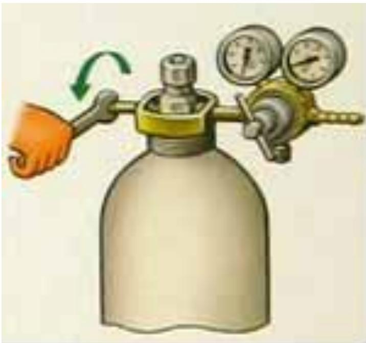
При присоединении ацетиленового редуктора следить за правильностью установки хомута.
