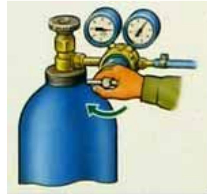
Вращением регулировочного винта установить рабочее давление.
