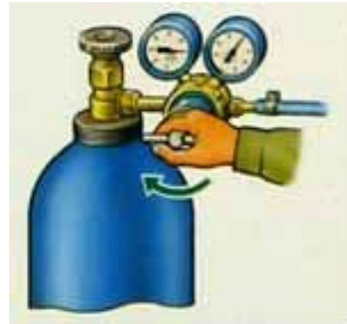
Вращением регулировочного винта установить рабочее давление.
