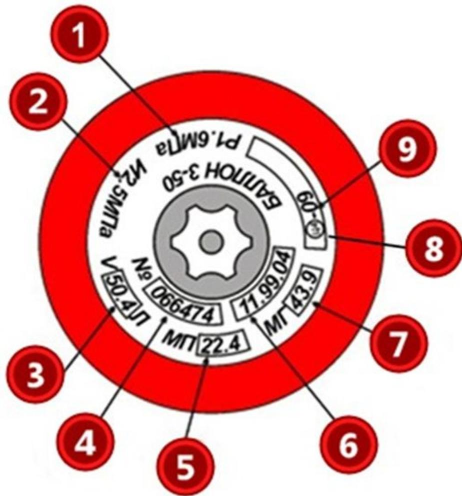
Надписи наносятся на специальный металлический шильдик, закрепленный в верхней части корпуса баллона вокруг вентиля:
