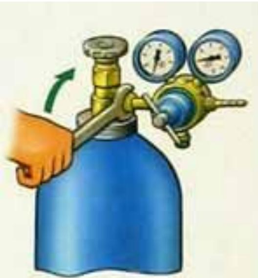
Затянуть накидную гайку редуктора ключом.
