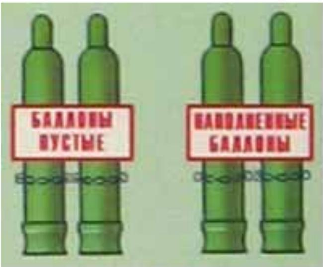
Наполненные и порожние баллоны хранят отдельно, обозначая места хранения соответствующими табличками
