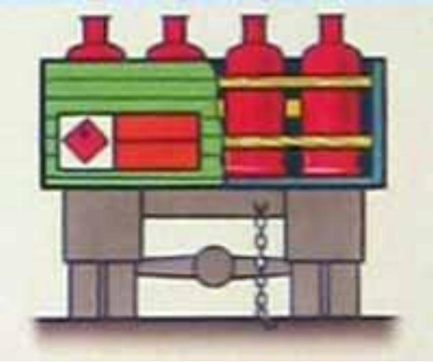
Пропановые баллоны допускается провозить в вертикальном положении без контейнеров, обязательно с прокладками между баллонами и ограждением их от падения.
