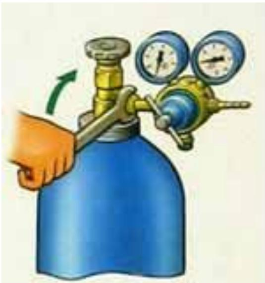
Затянуть накидную гайку редуктора ключом.
