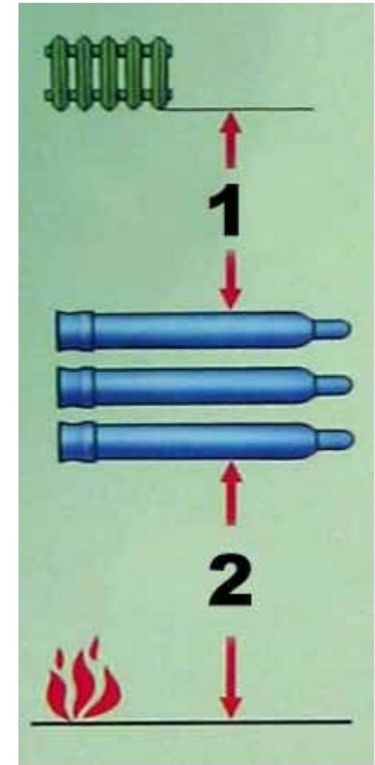
Баллоны должны быть защищены от солнца и осадков (максимальная температура корпуса баллона +45°C)
