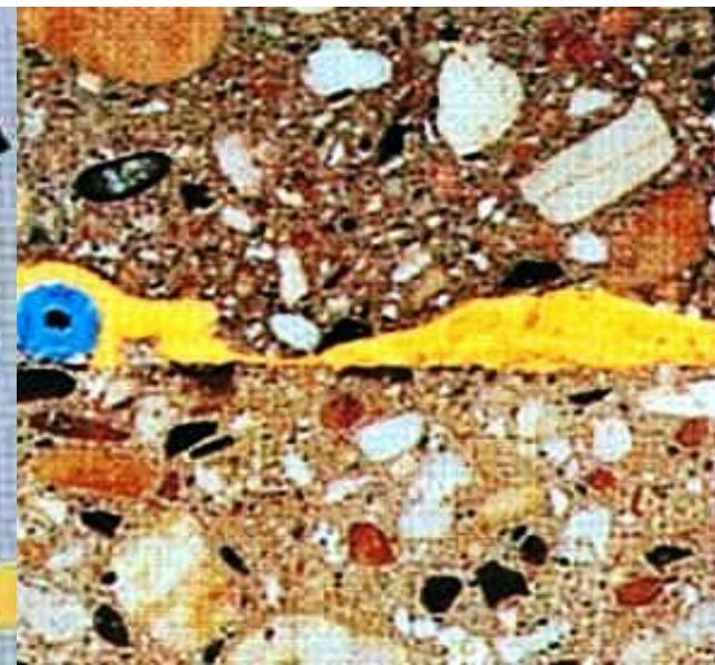
ЗАПОЛНЕНИЕ ШВА В НЕПРОФОРМОВАННОМ БЕТОНЕ
