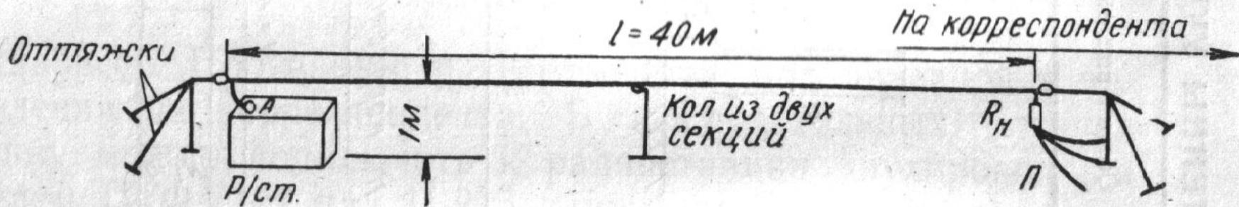
Рис. 3.6. Общий вид развернутой антенны бегущей волны
