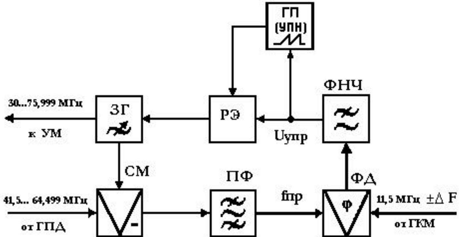
Система ФАПЧ задающего генератора передатчика
