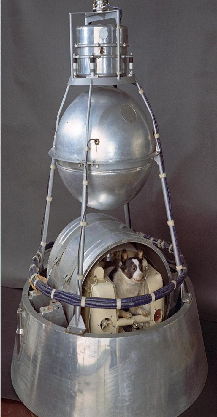
Второй Советский спутник был выведен на более вытянутую орбиту 3 ноября 1957 г. Гэтланд К. «Космическая техника» М., 1986 с .7 Если ракета первого спутника позволила поднять его на 947 км, то ракета второго спутника была более мощной. При почти той же минимальной высоте подъёма апогей орбиты достиг 1671 км, и спутник весил значительно больше первого - 508,3 кг.
