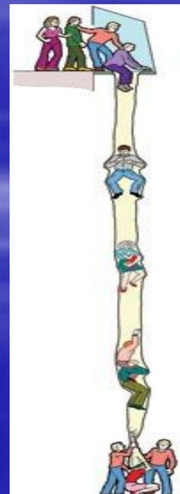
Устройства спасательные рукавные может быть размещено как снаружи, так и внутри здания с входом с одного или нескольких уровней одновременно. Конструкции устройств данного типа разрабатываются для каждого конкретного типа планировки здания или отдельного помещения.
