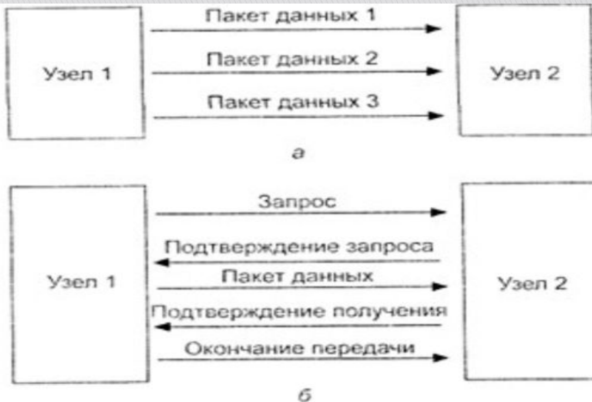
Рис. 2.6. Методы информационного взаимодействия: a — дейтаграммный; б — с установкой логического соединения
