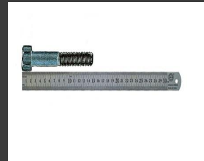
Замер длины болта линейкой
