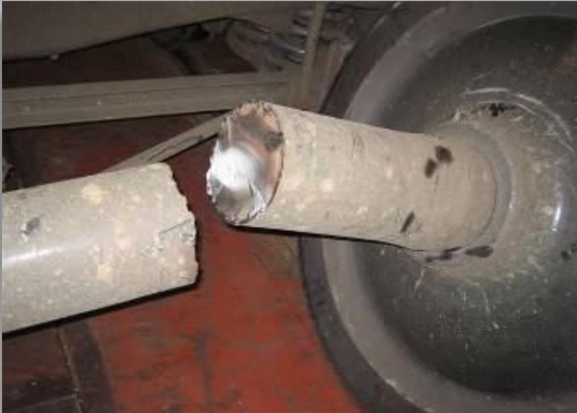
**разрушение оси под действием циклических нагрузок**
