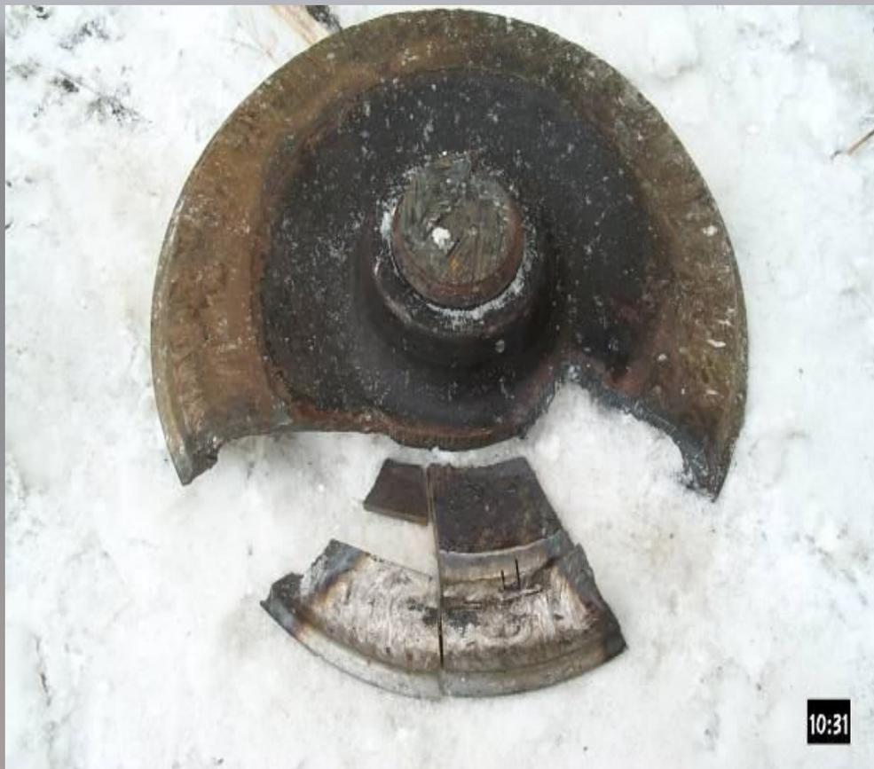
**разрушение колеса в результате развития трещины в диске
