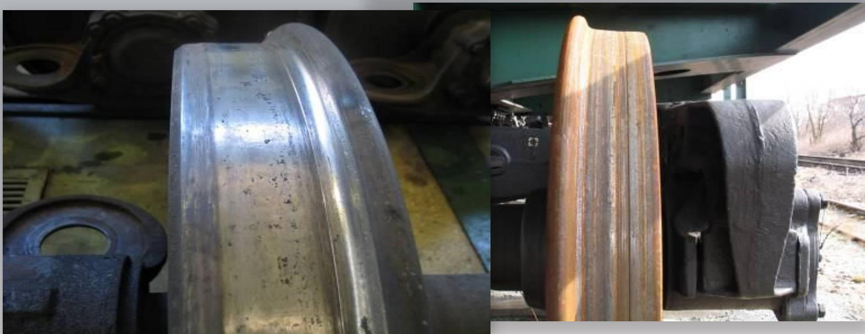
**неравномерный по поверхности катания колеса
