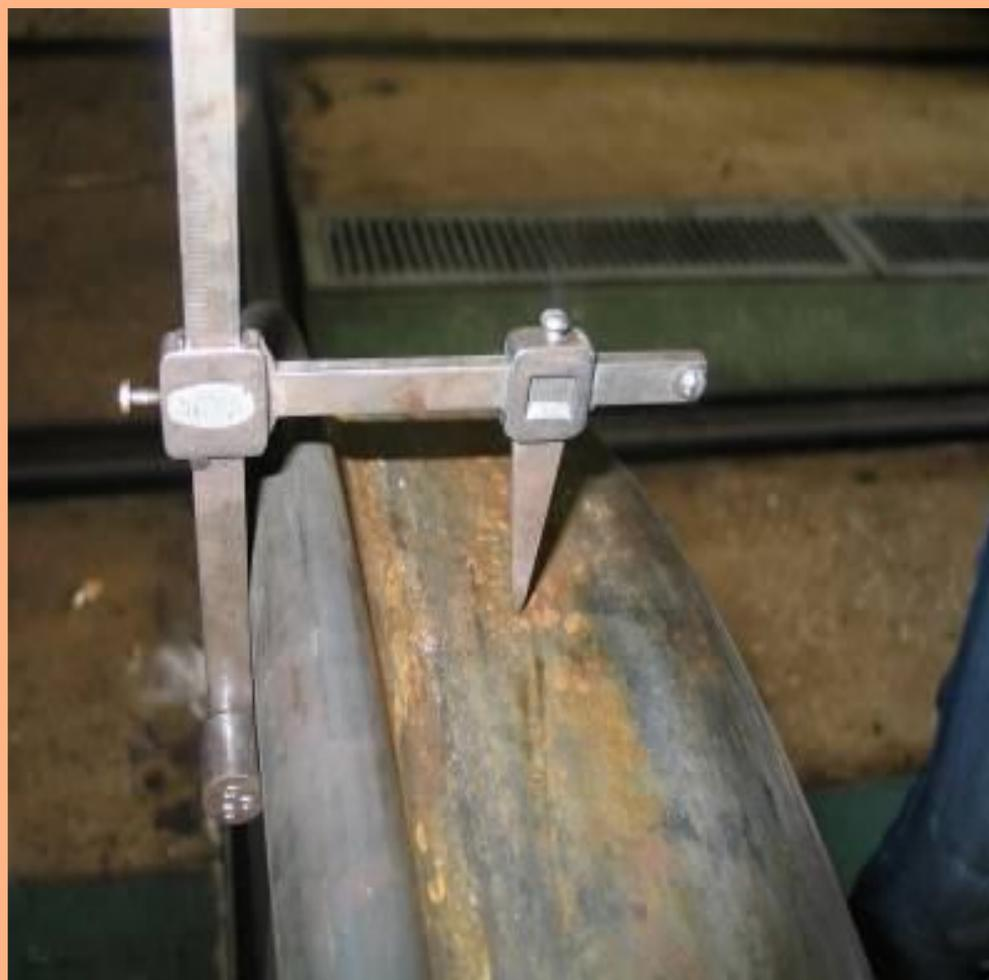
**толщина обода колеса менее допускаемых размеров**
