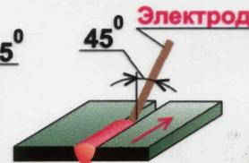
Сварка в нижнем положении обеспечивает наиболее благоприятные условия для формирования стыковых швов, благоприятные для угловых и легко поддается механизации.
