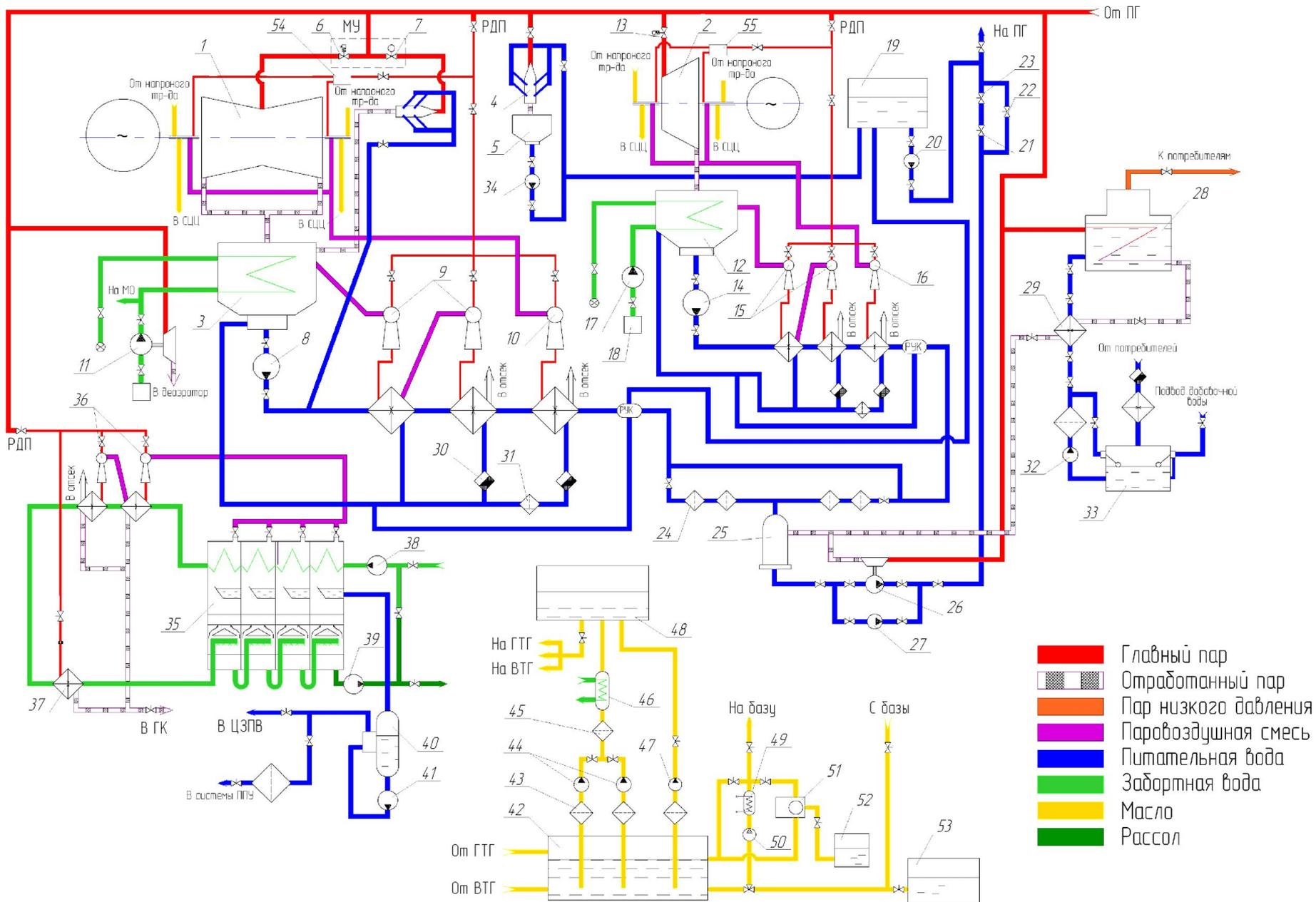
Рис. 1. Тепловая схема ПТУ ледокола
