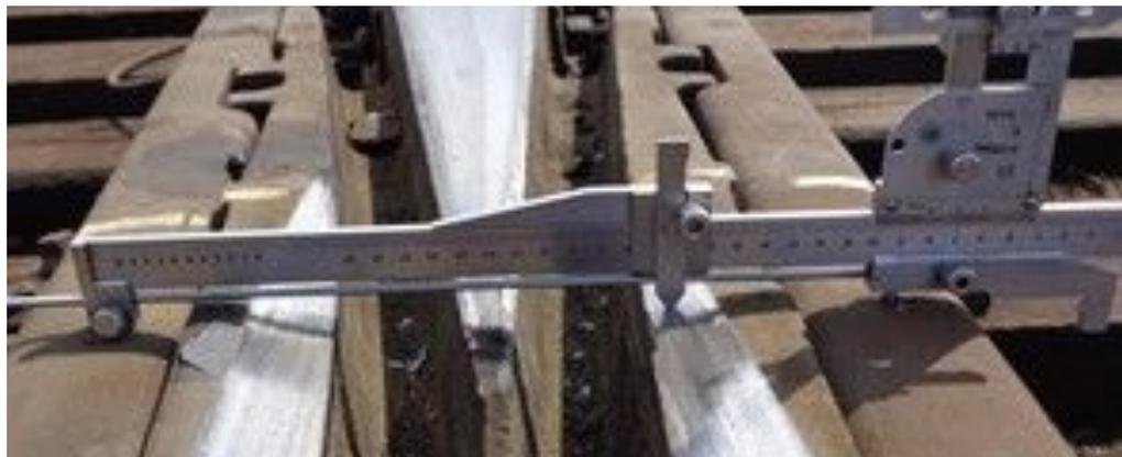
**Вертикальный износ усовиков сборных и цельнолитых крестовин измеряется на расстоянии 14 мм от боковой рабочей грани изнашиваемой части усовика в сечении, где ширина сердечника на уровне измерения равна 20 мм.**
