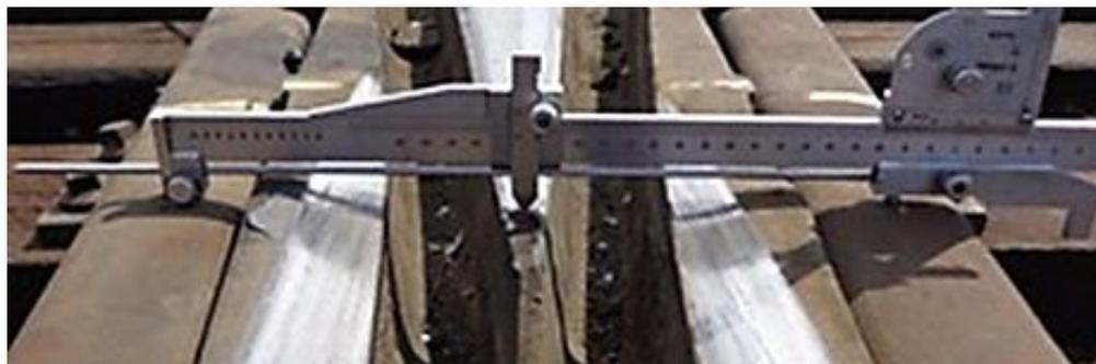
**Вертикальный износ сердечника сборных и цельнолитых крестовин измеряется по середине поверхности его катания в сечении, где ширина сердечника на уровне измерения равна 40 мм.**
