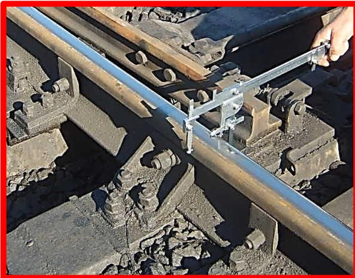
**Ширина головки нового рамного рельса**
