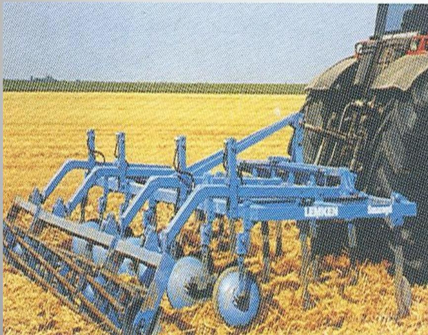
**Лушение** - приём обработки, при которой происходит рыхление, частичное оборачивание, перемешивание почвы и подрезание сорняков.
