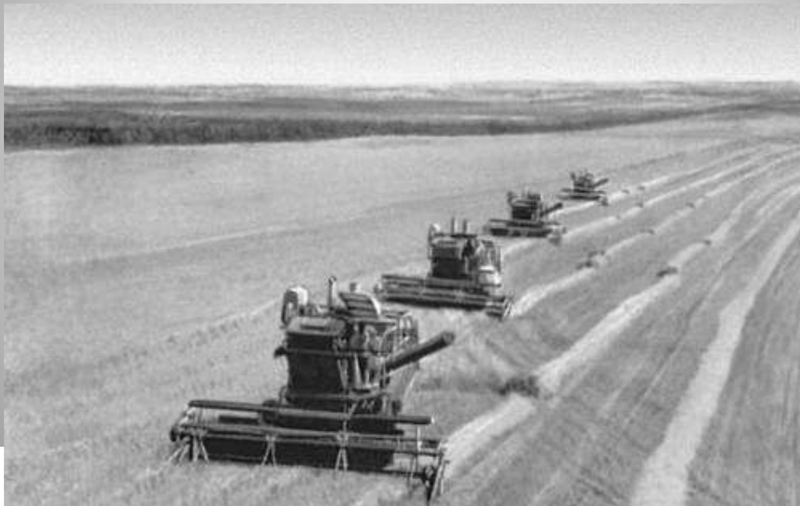
Валковые жатки предназначены для скашивания и укладки в валки зерновых и других культур с последующим их обмолотом. У валковой жатки нет шнека, вместо него она имеет **ременно-планчатый транспортер**
