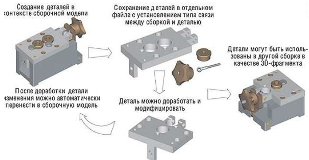
Моделирование деталей в контексте сборки (T-FLEX CAD)
