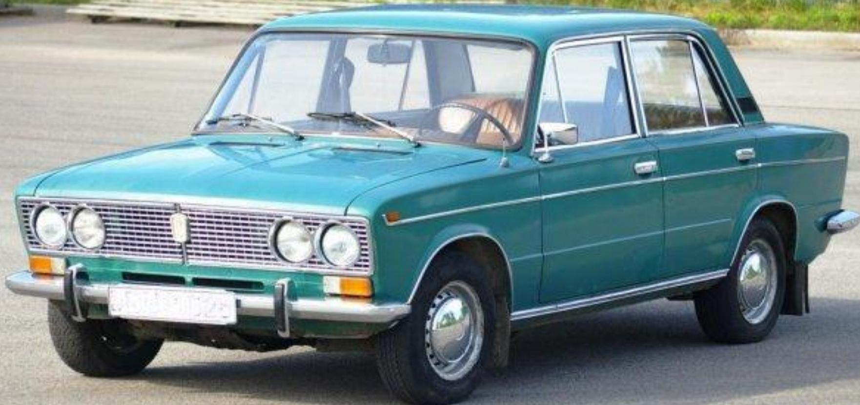
Третья модель ВАЗ – 2103 была оснащена двигателем объёмом 1,5 литра и мощностью равной 71 лошадиной силе, максимальная скорость до 152 км/час.
