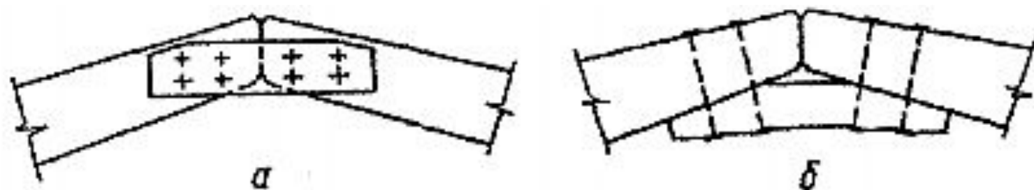
Рис. 8.15. Гребеневі вузли рам
