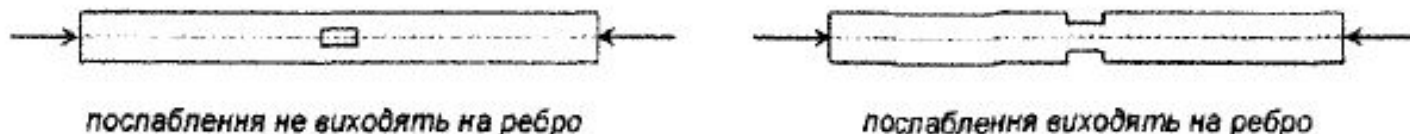
Рис. 4.2. Послаблення в центрально-стиснутих елементах
