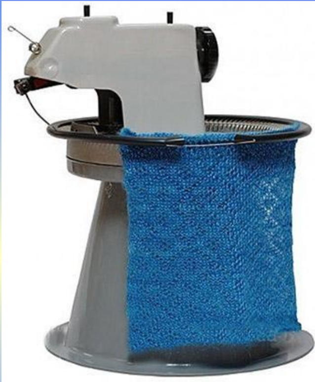
Рис. 8. Обробка трикотажних виробів на промисловій кетельній машині
